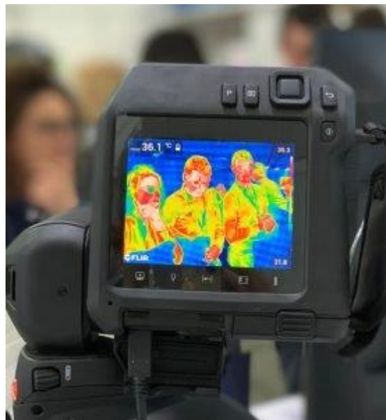
Fig. 2 – Telecamera termica mobile - EN 60601-1:2007 | EN 80601-2-59:2009
