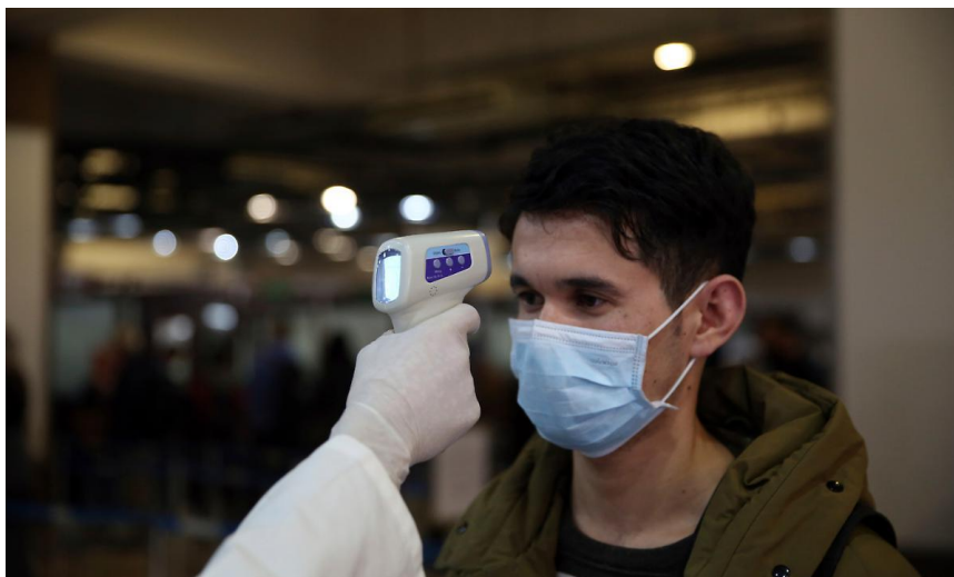
Fig. 3 – Termometro manuale a distanza - EN ISO 60601-1:2007 | EN 80601-2-57:2017
