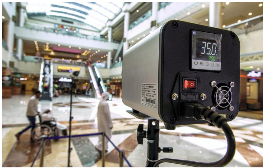
Fig. 1 – Telecamera termica fissa - EN 60601-1:2007 | EN 80601-2-59:2009
