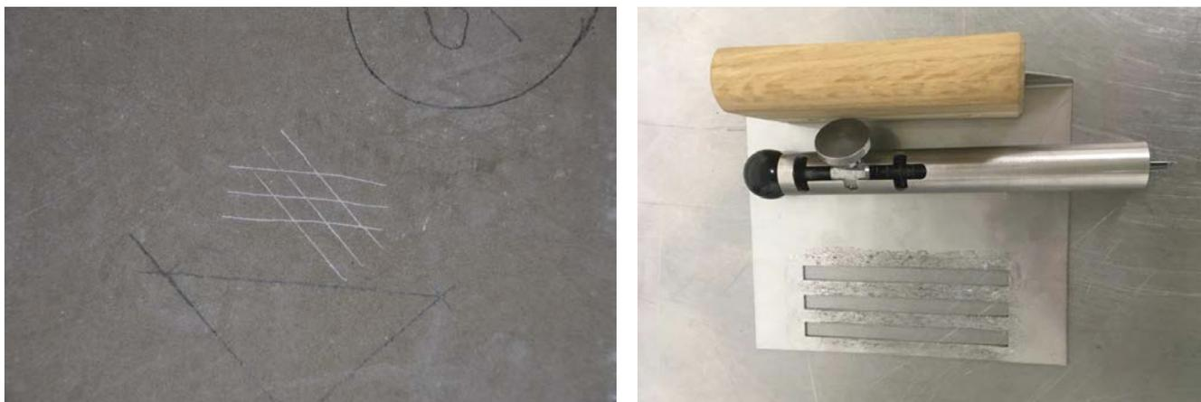
**Fig. 17 – Test per determinazione della durezza superficiale**
