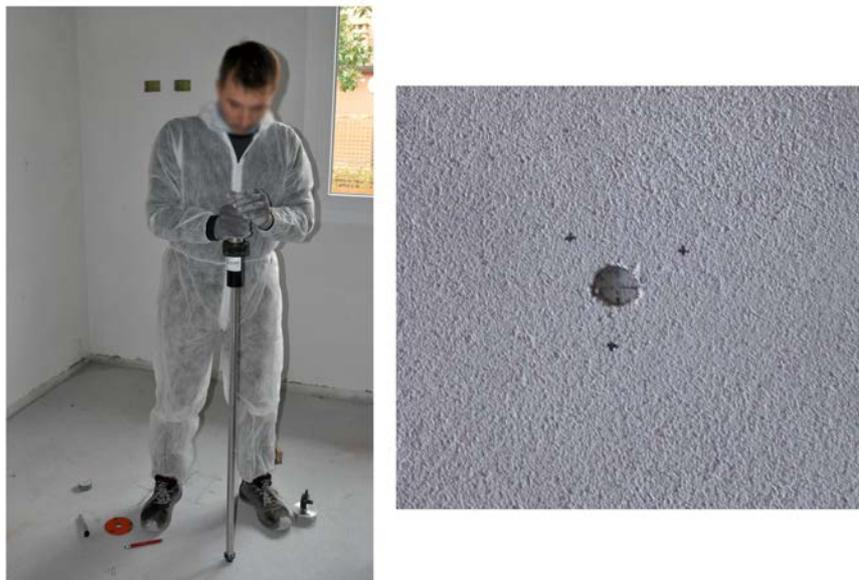
*Fig. 15 – Test per determinazione della resistenza all’impatto*
