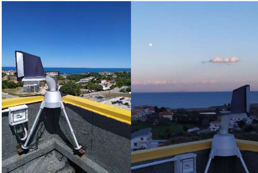
Figura 2.14.2 - Termoli, campionatore pollinico volumetrico VPPS Lanzoni 2000 - Isole Tremiti all'orizzonte (fonte: M.S.Bucci, Dip.ARPA Molise).
