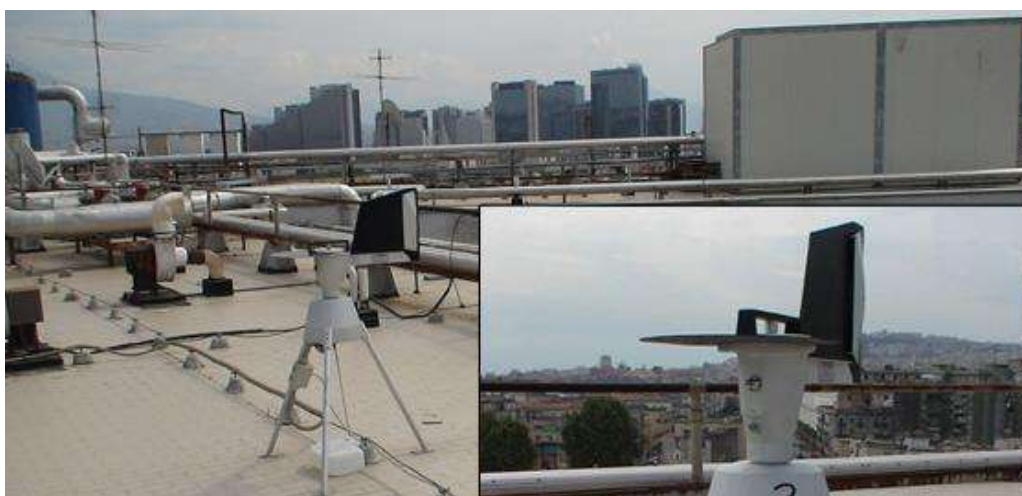
Figura 2.15.1 - Stazione di monitoraggio di Napoli: Catturatore tipo Hirst (Fonte: ARPA Campania)
