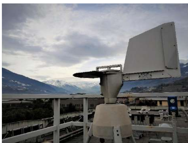
Figura 2.2.1 - St Christophe (tetto ARPA VdA) campionatore pollinico volumetrico (Fonte: ARPA VdA)
