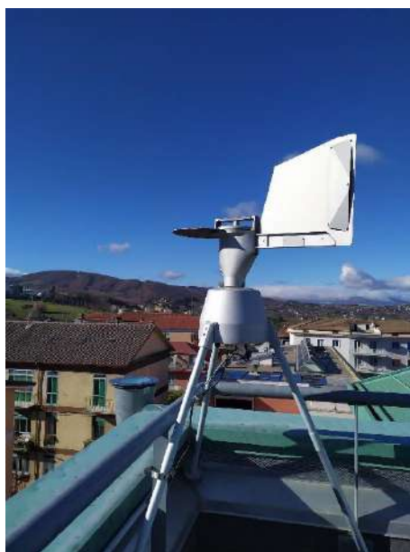
Fig. 2.14 1 - Campobasso, campionatore pollinico volumetrico VPPS Lanzoni 2000 (fonte: M.S.Bucci, Dip. ARPA Molise) Sullo sfondo un bosco di latifoglie composto in prevalenza da querce caducifoglie.
