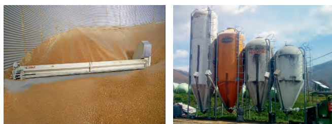
Figura 21 a) e b): a) Silos cereali con coclea di fondo; b) silos verticali mangimi (fonte Contarp Inail)
