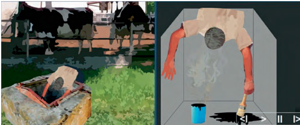
Figura 19: Incidente mortale occorso ad agricoltore durante una attività di impermeabilizzazione di una vasca di raccolta acqua piovana – fonte banca dati Infor.MO (fonte Dimeila, Inail)
