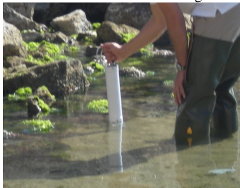
Figura 12.3 - Misura dei parametri chimico-fisici con sonda multiparametrica
