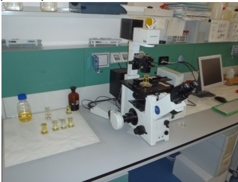
Figura 12.4 - Microscopio ottico invertito e camere di sedimentazione
