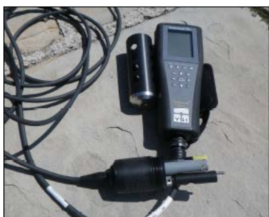
Figura 6.2 - Sonda da campo multiparametrica
