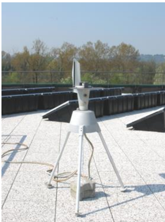
Figura 2.5.1 - Campionatore VPPS 2000, Lanzoni (fonte: ARPAV, Dipartimento provinciale di Vicenza).
