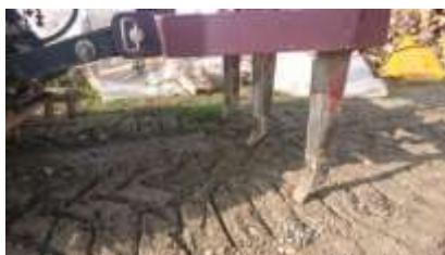
Figura 5.11.1 - Particolare di ripper per le lavorazioni superficiali autunnali di arieggiamento non distruttivo
