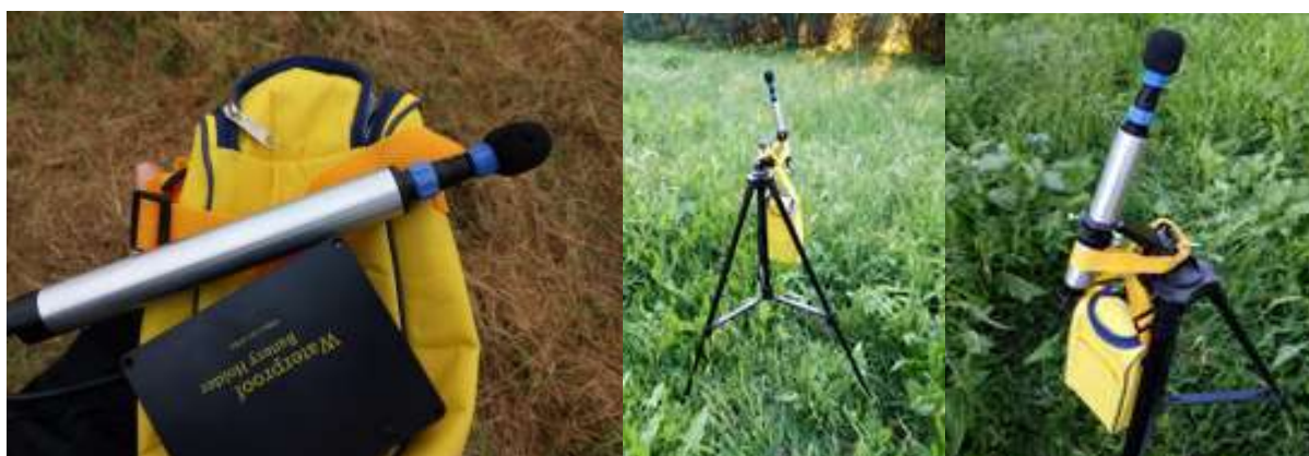
Figura 3.11.2 – Bat detector Ultramic Dodotronic 384K utilizzato durante i monitoraggi nei Noccioleti del Lazio
