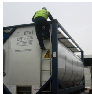
Figure 8.7 - Passer du passavant à l'échelle
