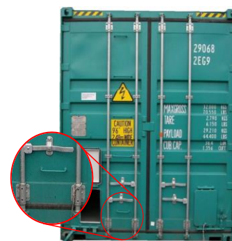
Figure 8.4 - Barreaux d'un conteneur pour vrac
