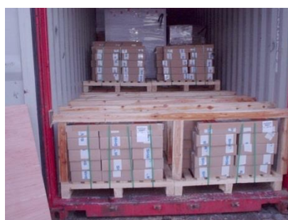
Figure 7.2 - Plancher temporaire en bois
