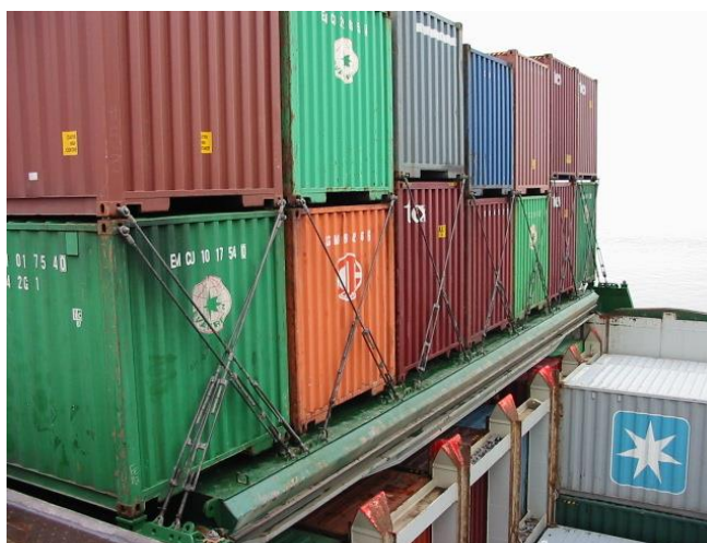
Figure 2.2 - Cellules de guidage et barres de saisissage à bord d'un porte-conteneurs
