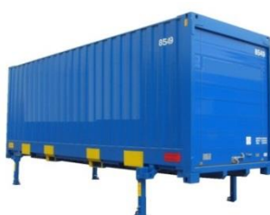
Figure 5.6 - Caisse mobile débarquée et positionnée sur béquilles
