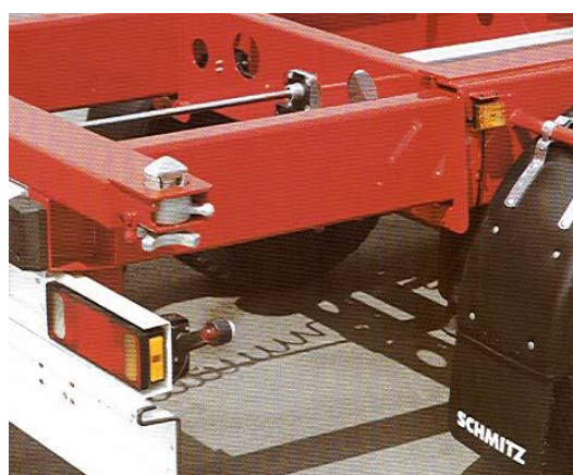
Figure 2.1 - Verrou tournant à bord d'un véhicule routier
