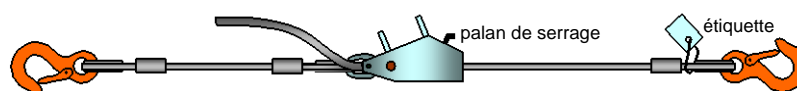
Figure 7.16 - Saisine en câble normalisée utilisée pour le transport routier munie d'un palan de serrage
