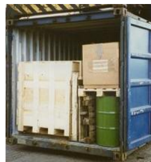
Figure 7.28 - Arrimage mixte avec utilisation de palettes
