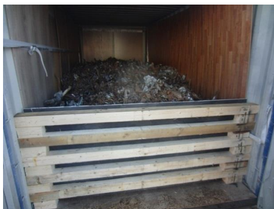
Figure 7.55 - Engin de transport chargé de ferraille doté d'un revêtement au niveau des parois et d'une barrière de porte
