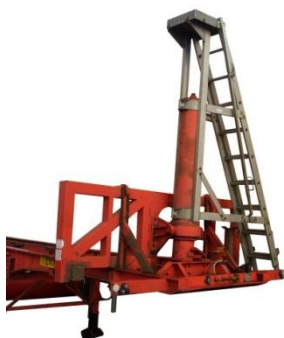
Figure 8.9 - Échelle d'accès fixée à la remorque
