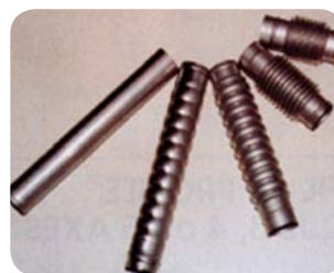
Piegatura di un tubo saldato in 430TT.
