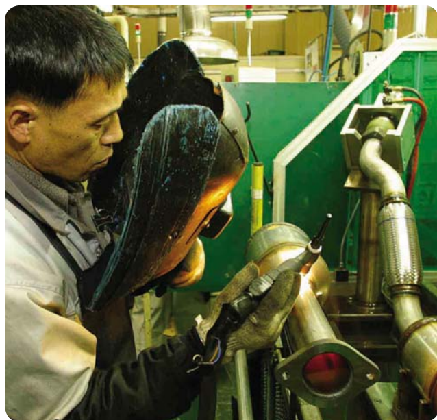
Saldatura di sistemi di scarico, tipo 437, Corea del Sud.
