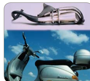
Tipo 1.4509/441, Centro Inox, Italia. La nuova Vespa ET2 è equipaggiata con una marmitta catalitica in ferritico
