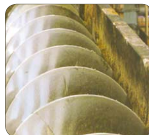
Tipo 1.4003/410, Columbus, Sud Africa. Qui il ferritico è durato più di 18 anni
