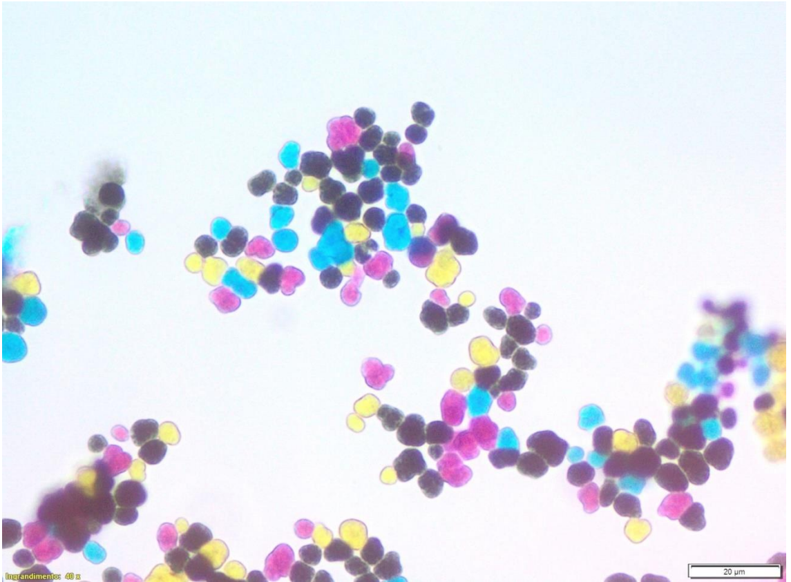
Figura 14.5.1: immagine al microscopio di polvere di toner. Vetrino preparato in laboratorio ARPA Umbria
