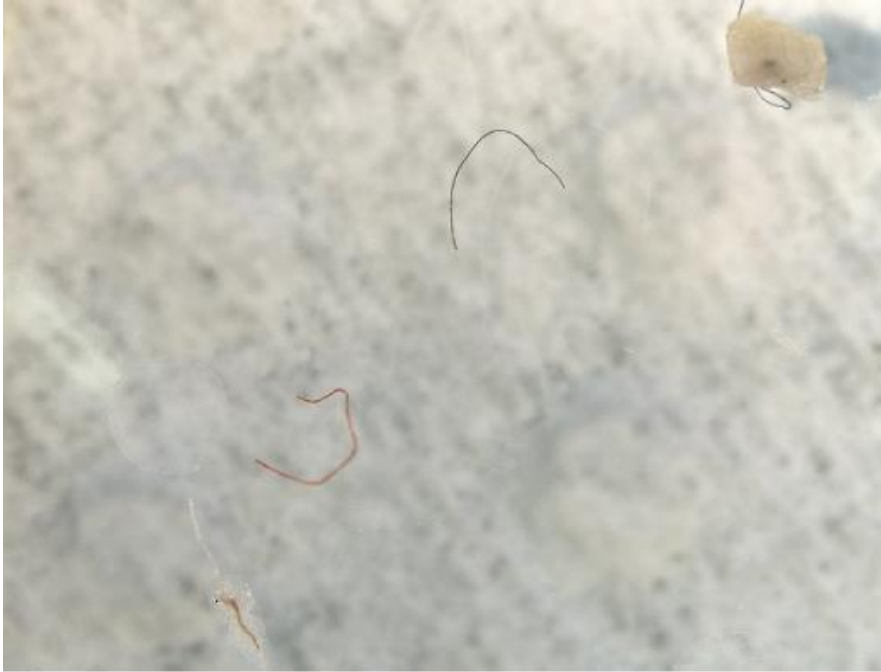
Figura 14.5.2. Immagine al microscopio ottico stereo di frammenti di microplastiche rinvenuti in campioni di acqua marina, per gentile concessione del dott. Francesco Cumani – ARPA FVG
