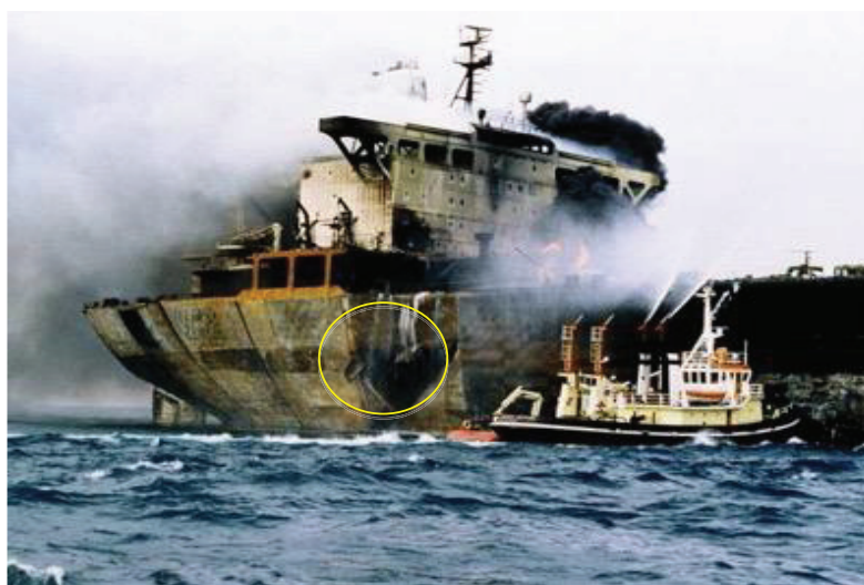
Immagine 33 – Agip Abruzzo: Falla sulla murata di dritta - area di impatto
