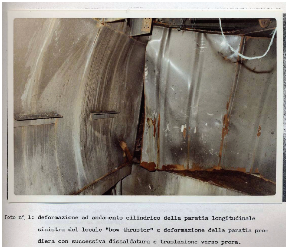
Figura 13. Deflessione della paratia longitudinale sinistra del locale motore elica di manovra e parte di quella di prua con aperture in corrispondenza delle linee di saldatura, viste dall'interno (dalla Relazione della Commissione Permanente per gli Esperimenti del Materiale da Guerra della Marina Militare Italiana).
