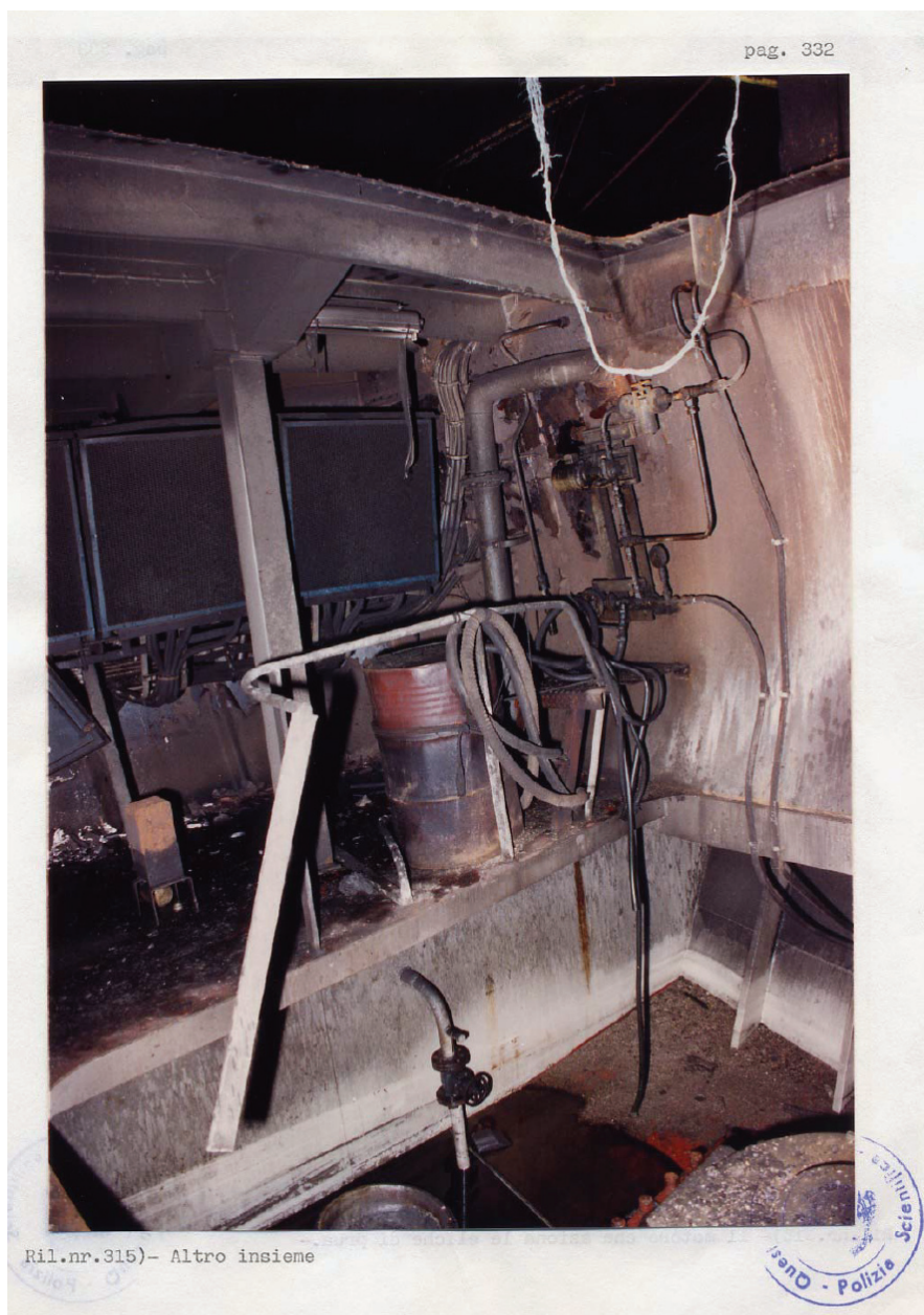
Figura 14. Visione generale del locale motore elica di manovra, con ben evidente il barile metallico non deformato e privo di perforazioni visibili (dal fascicolo della Polizia Scientifica).
