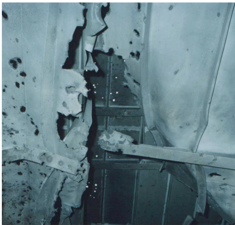
Figura 5. Strappi e perforazioni delle lamiere dovuti all'esplosione di una carica di esplosivo ad alto potenziale nel compartimento di una nave, è possibile anche notare le perforazioni nella paratia oltre la lamiera strappata.
