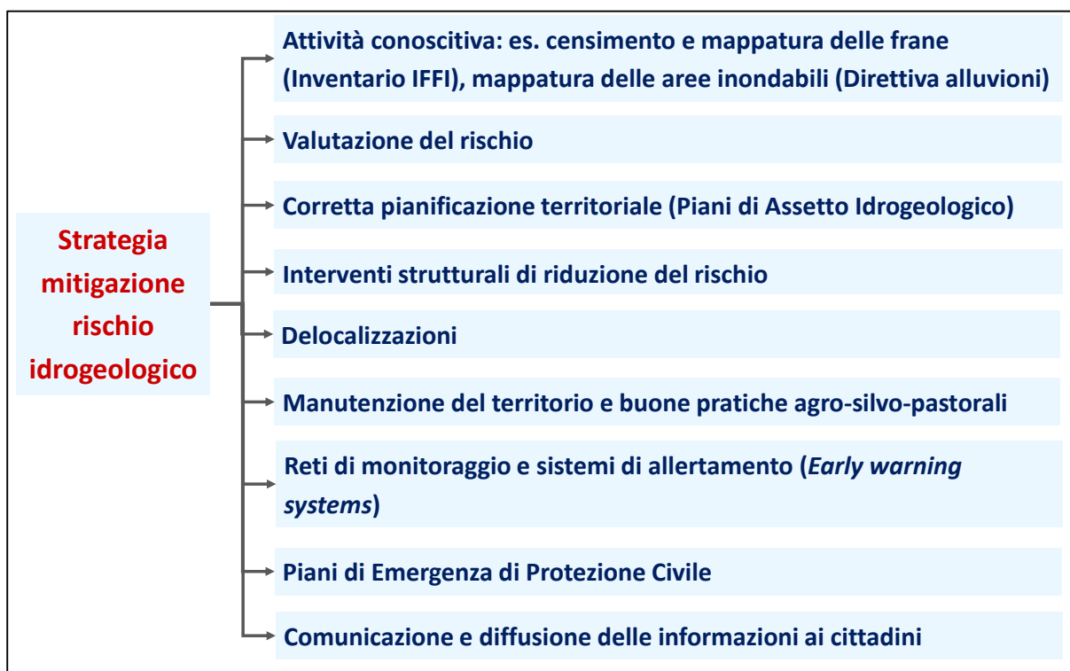
Figura 1.6 Strategia per la mitigazione del rischio idrogeologico (modificato da Bazzoffi et alii, 2013)
