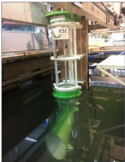
Figura 16 - Dispositivo WaveSAX Installazione tipica in un antimurale portuale. [Fonte: RSE S.p.A.]
