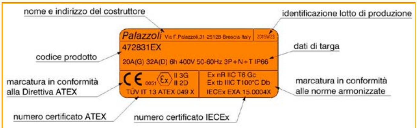
Figura 30: esempio etichetta di una presa interbloccata ATEX Palazzoli
