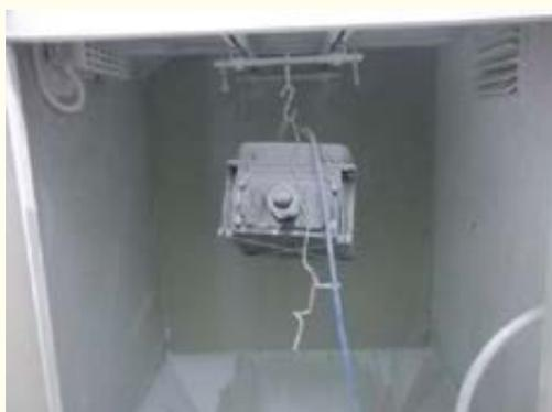
Figura 23: esempio prova IP POLVERE
