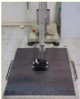
Figura 22: prova d'urto
