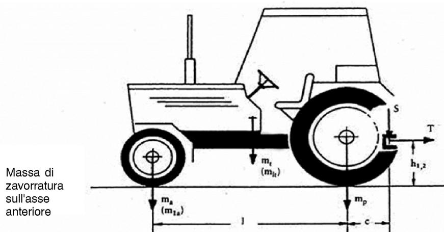
3.4.1. ► **M1** Per i dispositivi di accoppiamento meccanici dei trattori, tutti i trattori con massa massima tecnicamente ammissibile a pieno carico superiore a 2,5 tonnellate devono essere muniti di un dispositivo di accoppiamento la cui altezza dal suolo sia conforme a una delle formule seguenti: ◀
