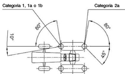
Il valore di  $10^\circ$  per l'angolo di visibilità interno dell'indicatore anteriore può essere ridotto a  $3^\circ$  per i veicoli con una larghezza fuori tutto che non supera i 1 400 mm.
