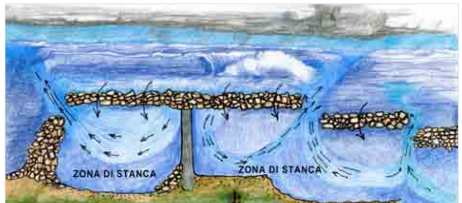
Figura 13: schema di circolazione nelle vasche semichiusse.
