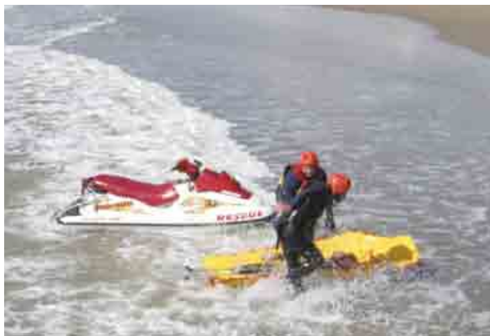
Foto 18: la barella può anche essere semirigida (come in foto) e l'equipaggio della moto d'acqua deve sempre portare tutte le dotazioni prescritte (foto Giaro, Roma).
