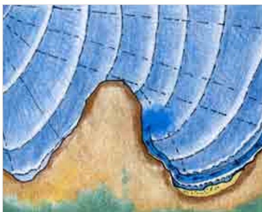
Figura 6: quando il moto ondoso entra in tralice in una baia possiamo aspettarci che una corrente di ritorno esca dal lato opposto della baia.
