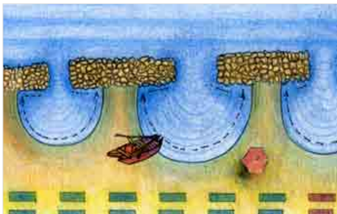
Figura 9: formazione di tomboli per effetto delle onde entranti dai varchi.
