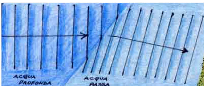
Figura 4: schema di rifrazione delle onde.
