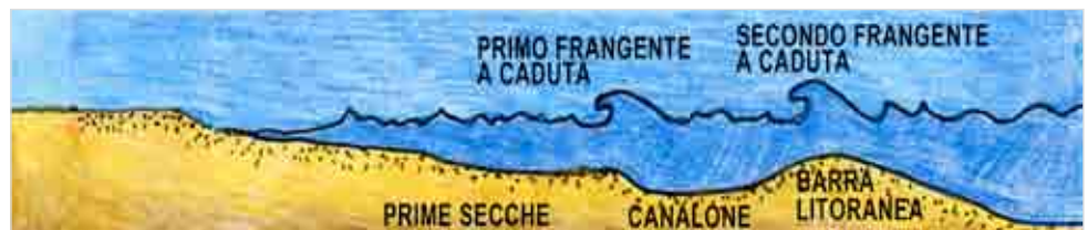
Figura 3: profilo estivo del fondale antistante di spiagge dominate dalla corrente.
