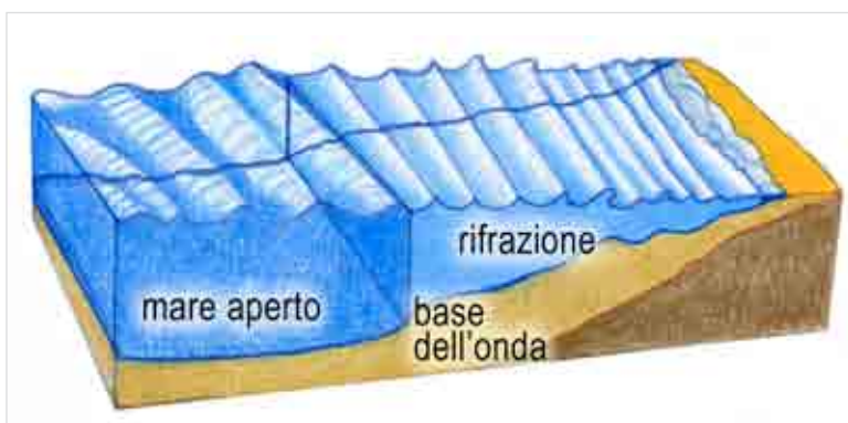
Figura 5: rifrazione delle onde.
