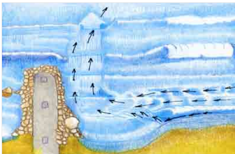
Figura 1: un pennello trasforma la corrente di deriva in una pericolosa corrente di ritorno.
