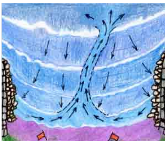
Figura 7: corrente di ritorno provocata da due pennelli.
