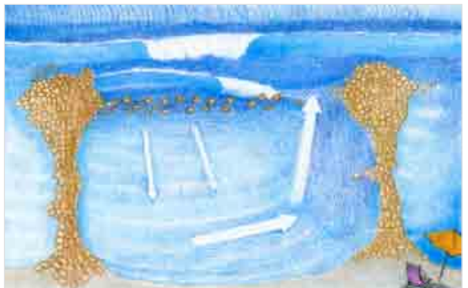
Figura 12: corrente di uscita in una vasca semiaperta.
