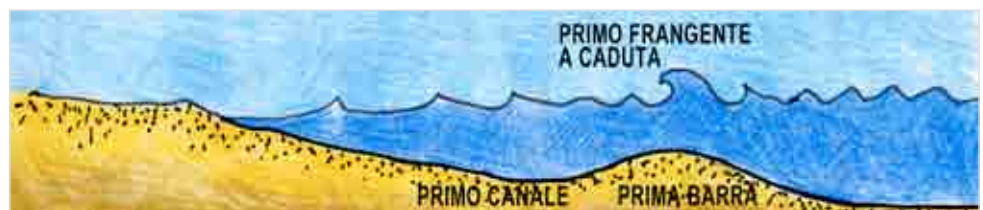
Figura 4: profilo invernale del fondale antistante di spiagge dominate dalla corrente.
