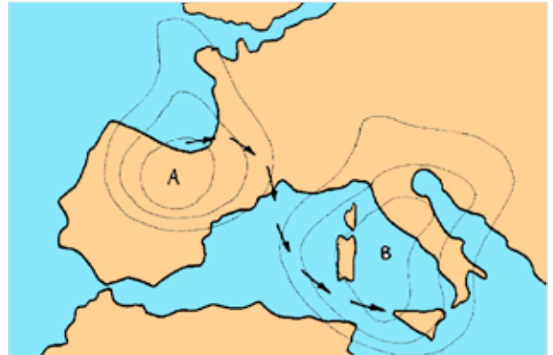
Figura 1: l'aria migra dalle zone ad alta pressione a quelle a bassa, originando il vento.
