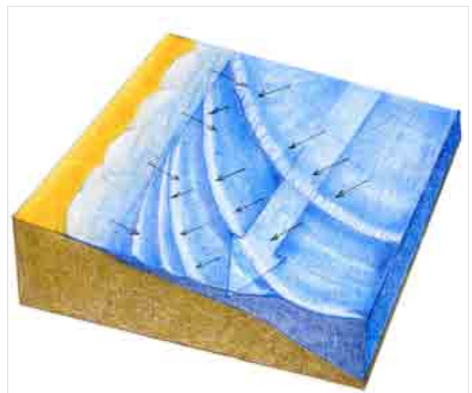
Figura 14: si ha formazione di una corrente litorale quando le onde incidenti ad angolo si scontrano con la risacca.
