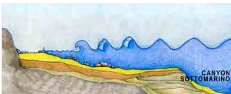
Figura 2: lo strato di sabbia o ghiaia riposa su uno strato di roccia; se la sabbia finisce oltre il limite superiore della spiaggia (chiusura) cade in un canyon e diventa irrecuperabile.
