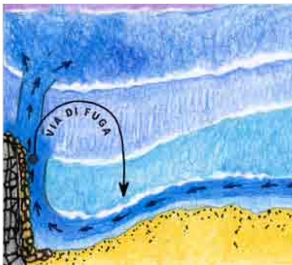
Figura 6: via di fuga dalla corrente del pennello.
