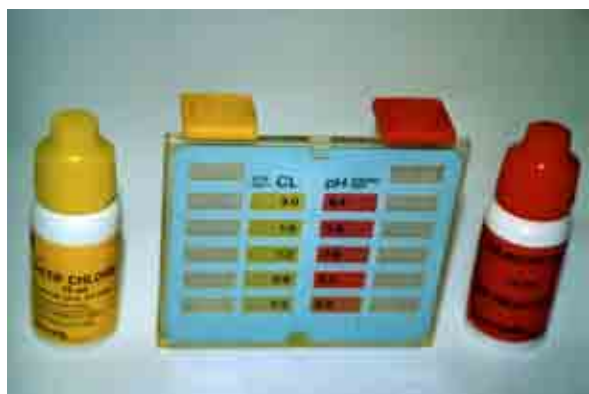
Foto 5: per la misurazione manuale del cloro e del pH si usano apposite vaschette colorimetriche
