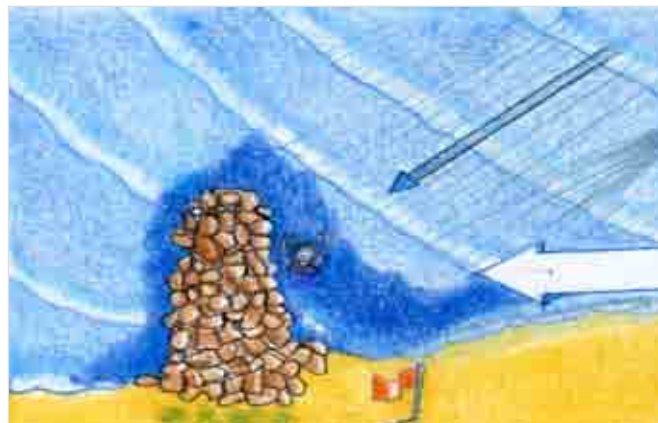
Figura 5: effetto congiunto di moto ondoso, vento e corrente di deriva sul pennello.
