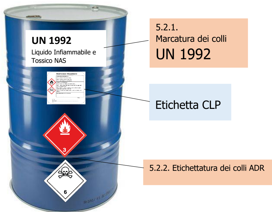
Fig. 3 - Etichettatura completa tipo su un imballaggio semplice ADR e CLP
