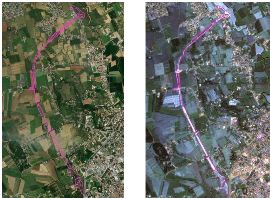
Figura 149. Cantieri stradali per la costruzione della tangenziale a ovest di Vicenza; immagine 2017 a sinistra e 2019 a destra. Nel 2019 i cantieri hanno occupato circa 30 ettari
