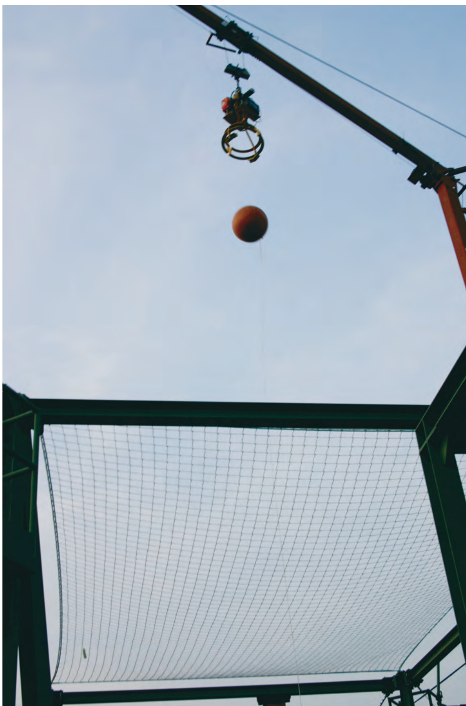
Figura 3.1.1-2 - Prova di resistenza dinamica delle reti di tipo S. Sfera durante la caduta
