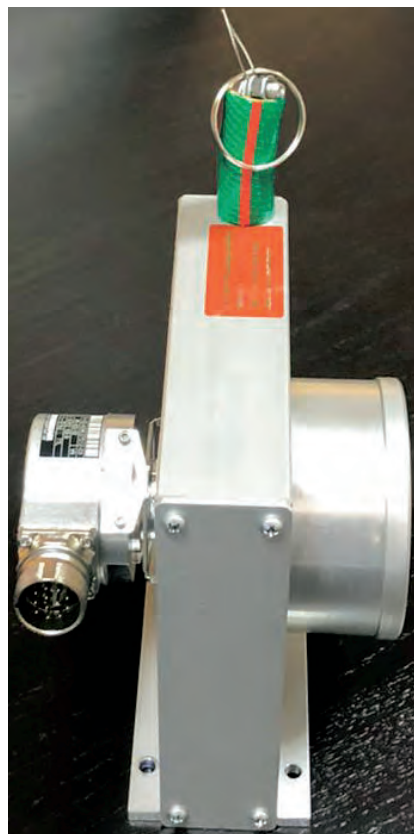
Figura 4.2.2.3-3 - Sensore di posizione a filo
