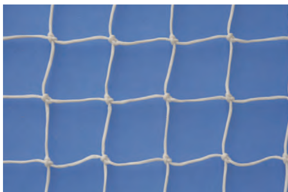
Figura 4.2.2.2-2 - Esempio di rete in polietilene con maglia 100x100
