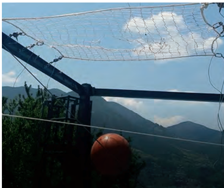
Figura 4.4.5.-9 Rete quadrata 2x2 (m) h = 4 m - Sfondamento della rete (fermo immagine)
