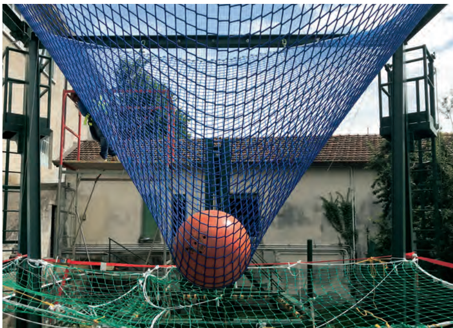
Figura 4.4.3.-8 - Deformazione finale della rete - 8 ancoraggi. Rete 5x5 (m), maglia 60x60 (mm), h = 0 m
