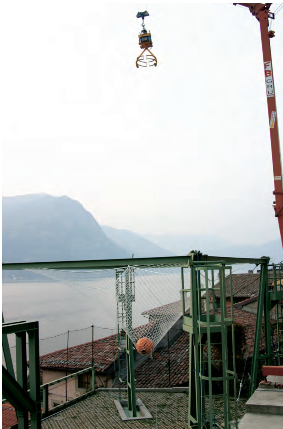
Figura 3.1.1-3 - Prova di resistenza dinamica delle reti di tipo S. Sfera alla fine della caduta in posizione di riposo
