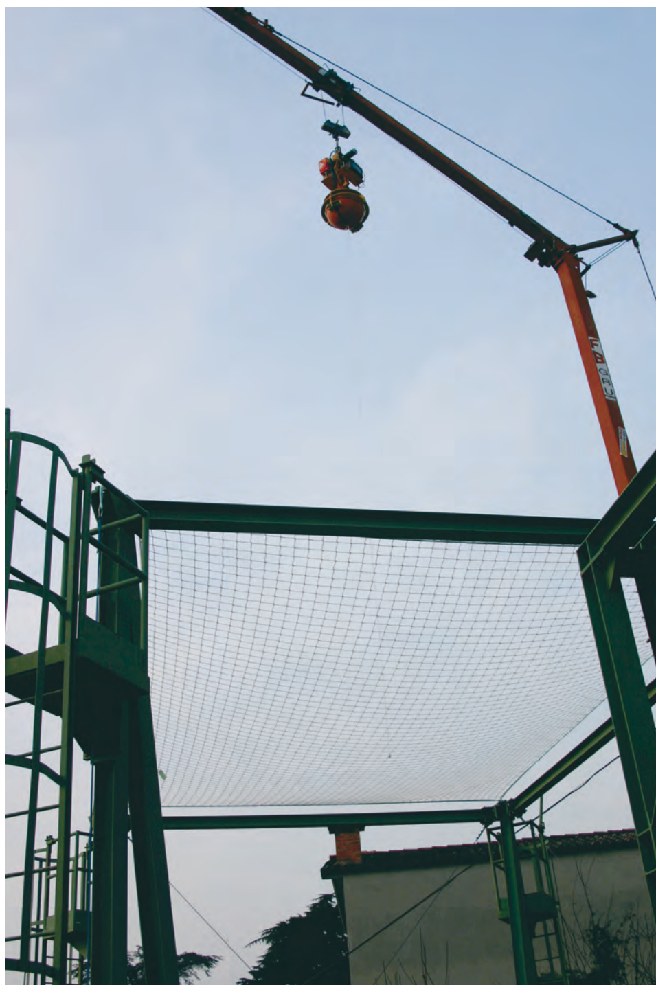
Figura 3.1.1-1 - Prova di resistenza dinamica delle reti di tipo S. Sfera prima della caduta
