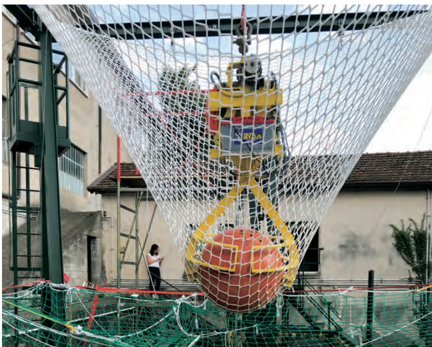
Figura 4.2.2.5-5 - Sistema di sollevamento e sgancio Recupero della sfera di prova dopo la caduta
