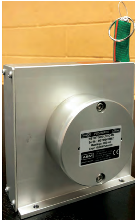
Figura 4.2.2.3-2 - Sensore di posizione a filo
