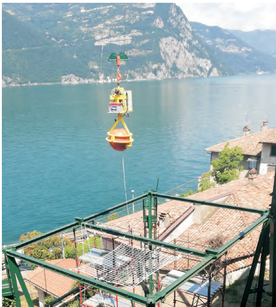
Figura 4.4.5.-8 - Rete quadrata 2x2 (m) - h = 4 m inizio prova (vista dall'alto)
