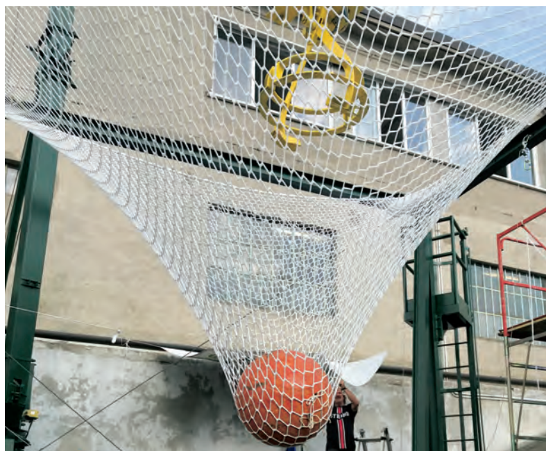
Figura 4.4.2.-24 - Prova di caduta - 4 ancoraggi. Rete 3x3 (m), maglia 60x60 (mm), h = 3 m
