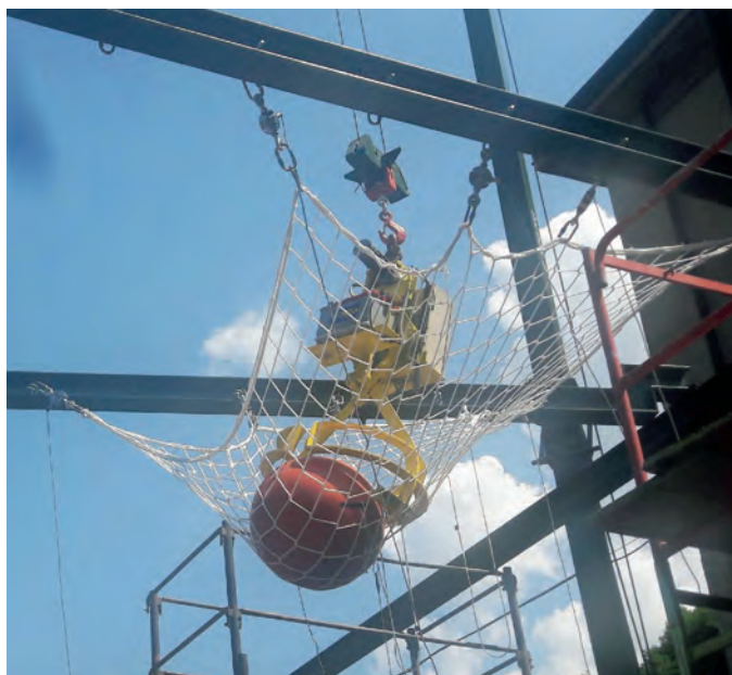
Figura 4.2.2.5-4 - Sistema di sollevamento e sgancio Particolare del riaggancio della sfera di prova dopo la caduta
