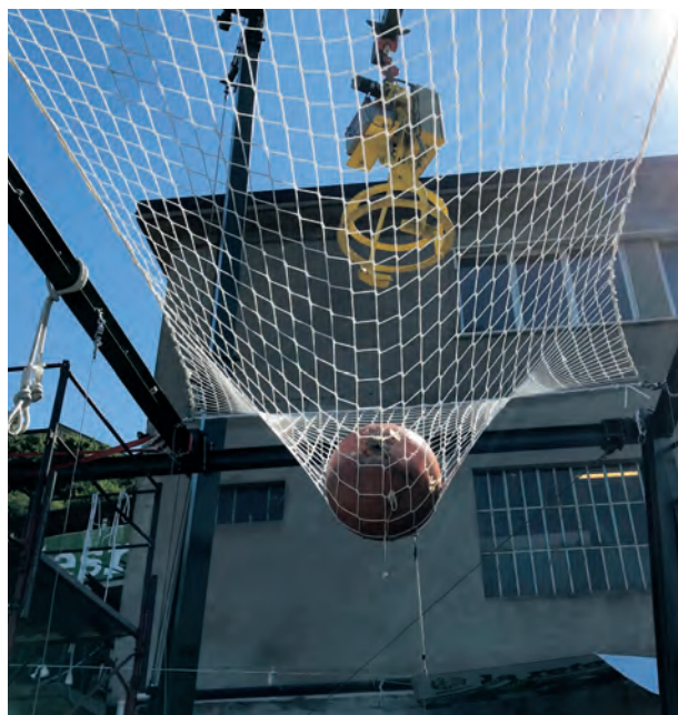
Figura 4.4.2.-25 - Prova di caduta - 4 ancoraggi. Rete 3x4 (m), maglia 100x100 (mm), h = 1 m
