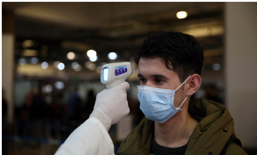
Fig. 3 – Termometro manuale a distanza - EN ISO 60601-1:2007 | EN 80601-2-57:2017
