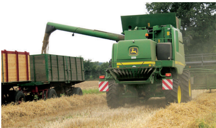
Figura 4.4 - Scarico dalla mietitrebbia al rimorchio; fonte: http://www.agrarservice-repenning-specht.de/index.php?do=Getreideernte
