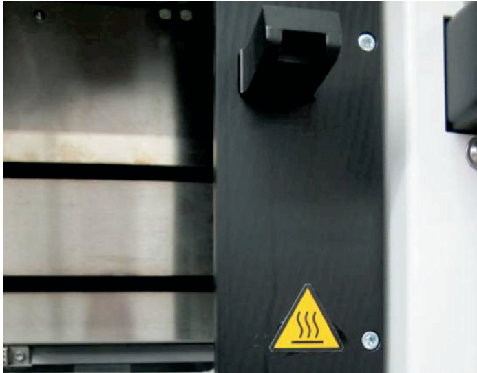
Figura 15: Avvertimento di pericolo dovuto a parti con elevata temperatura
