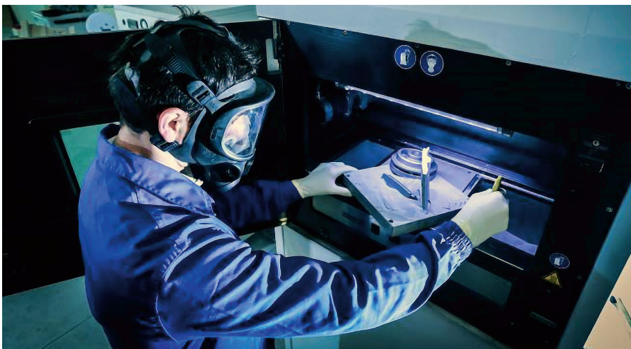
Figura 5: Fase di estrazione di parti finite da una macchina powder bed fusion/sintering
