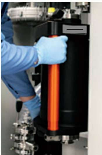
c) Rimozione/collocamento di elemento filtrante
