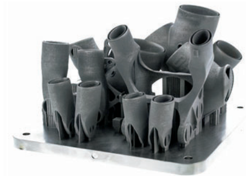
a) Piastra con oggetti costruiti al termine della lavorazione
