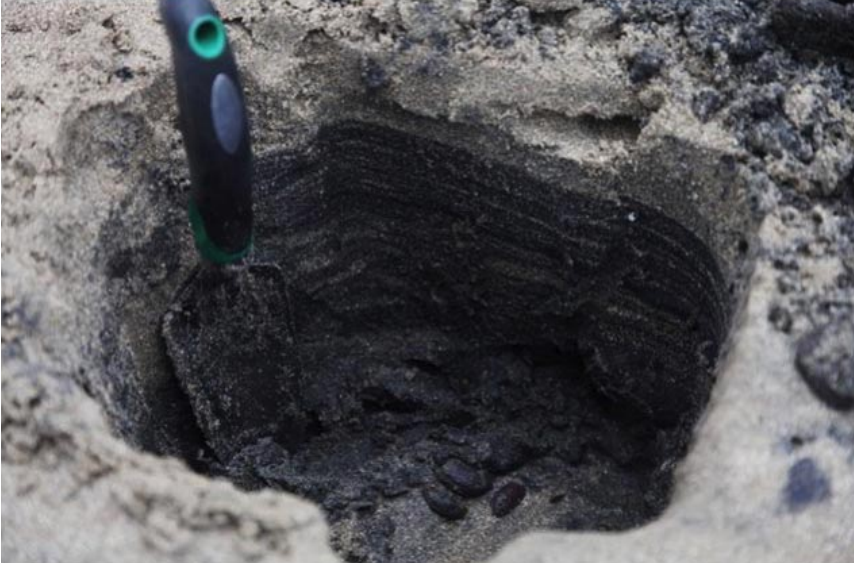
Foto 9.4. Incidente Eon Porto Torres, 2011. Saggio sub-superficiale (quote sezione) effettuato nel corso delle operazioni cccc nella spiaggia xxxx.
