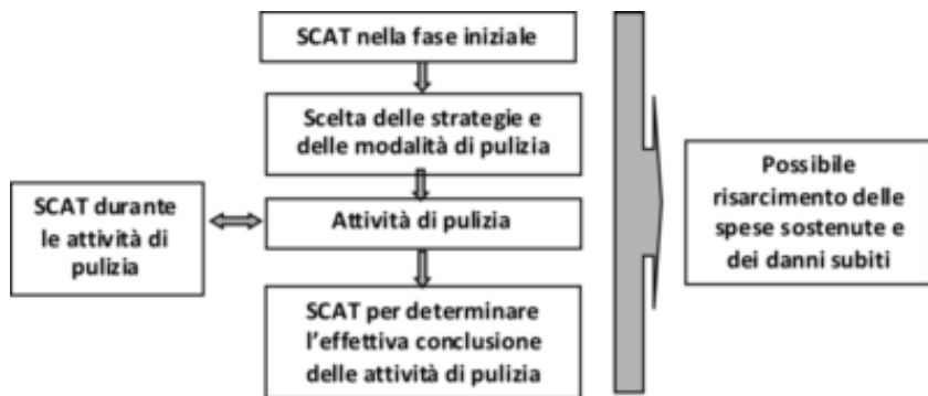
Figura 11. Lo SCAT nel flusso delle azioni di contrasto all'inquinamento a seguito dell'arrivo sulla costa di prodotti di un oil spill.
