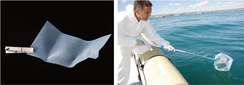
Figura 5 - Foglio di polimero adsorbente (es. Teflon®/fluoretex®); a destra fase di campionamento di chiazze oleose cospicue con il metodo del Cono di Teflon®. Analoga configurazione viene utilizzata nel campionamento con retino degli aggregati idrocarburici; è impiegato anche per il prelievo in mare di strati sottili, iridescenze e per il campionamento da sorgenti sospette (cisterne, condutture, tubature, ecc.)
