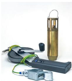
Figura 8 - Campionatore cilindrico a base conica in ottone per tubazioni, cisterne e condutture; nastro acciaio di lunghezza min. 30 m; dispositivo per la messa a terra del campionatore
