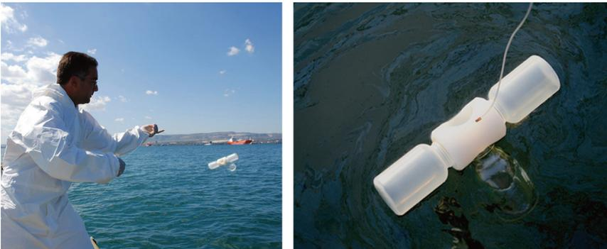
Figura 6 - Unità di campionamento di prodotto dalla superficie marina, denominata "Bottiglia Shomaker" o "Unità Shomaker"; a sinistra in fase di lancio in acqua, a destra in fase di prelievo dello strato superficiale marino, di iridescenze e pellicole avente spessore <math><1\text{mm}</math>
