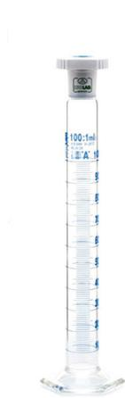
Figura 10- Cilindri graduati muniti di tappo, impiegati in test di dispersibilità (SINTEF, <https://www.sintef.no/en/>)
