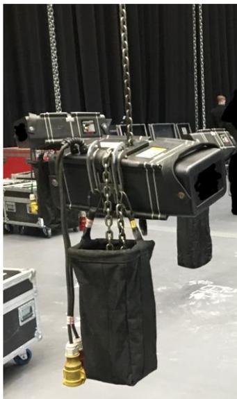
Figura 13 - Macchine scenotecniche: paranchi (c.d. motori)
