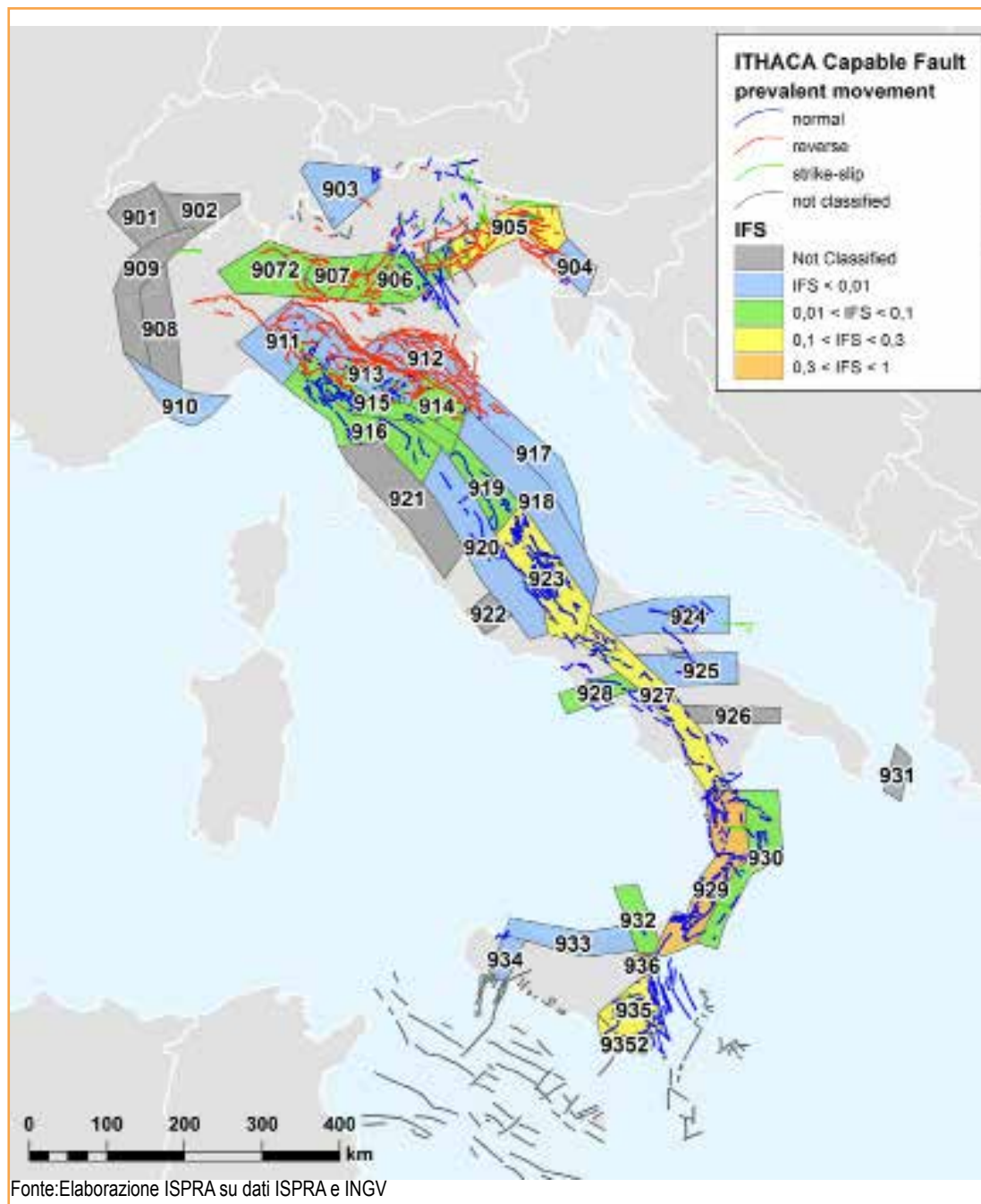
Figura 14.6: Classificazione delle zone sismogenetiche ZS9 in funzione dell'indice IFS
