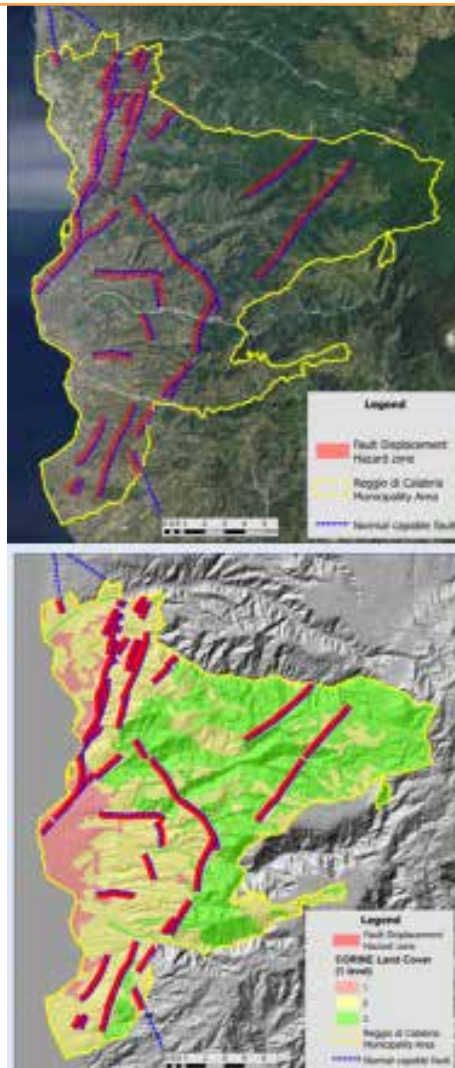
Figura 14.10: Mappa delle aree a elevata pericolosità da fagliazione superficiale nel territorio di Reggio Calabria; mappa di copertura del suolo
