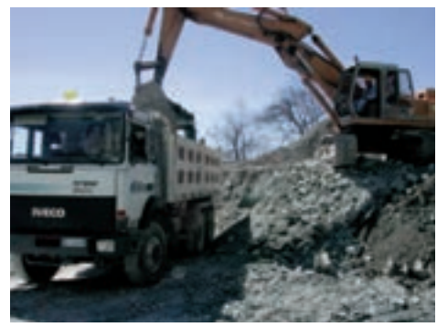
Figura 37 Carico del materiale friabile in cava
