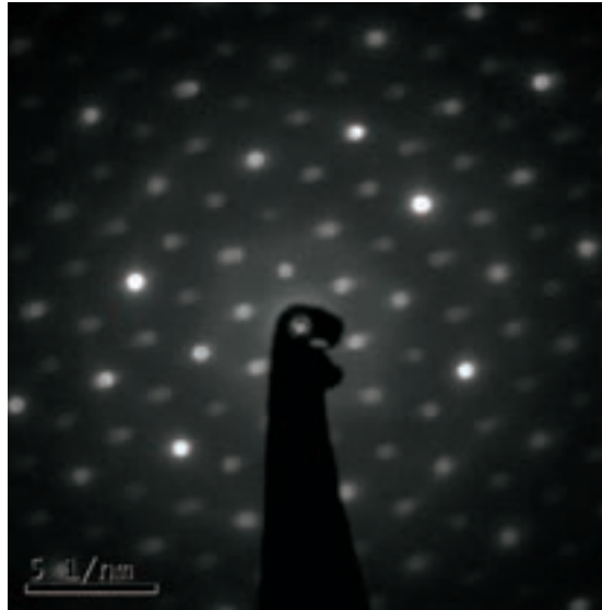
Nanodiffrazione di una fibra di antigorite
