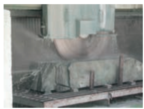
Figura 40 Taglio delle lastre con lame diamantate
