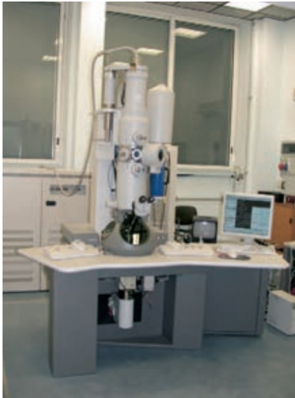
Figura 17 Microscopio elettronico a trasmissione presente nel Laboratorio interazioni sinergiche tra rischi del Dimeila - Inail
