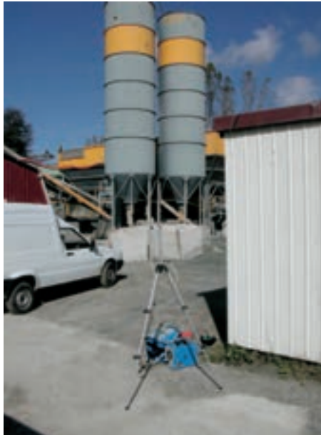
Figura 48 Campionatore ambientale in zona silos
