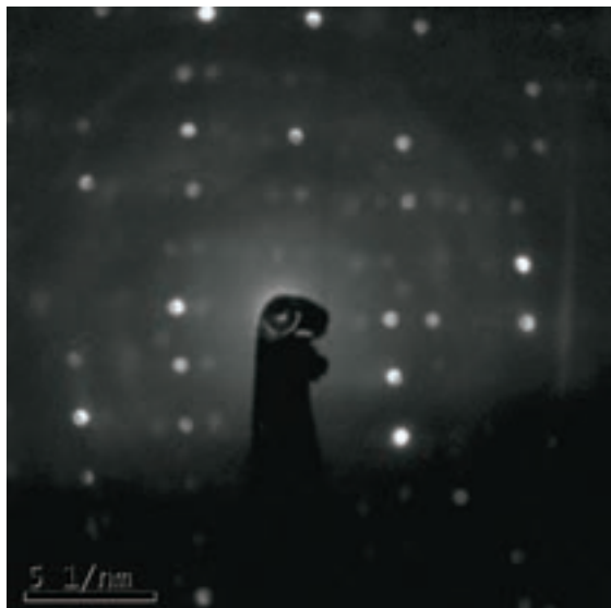
Nanodiffrazione di una fibra di tremolite
