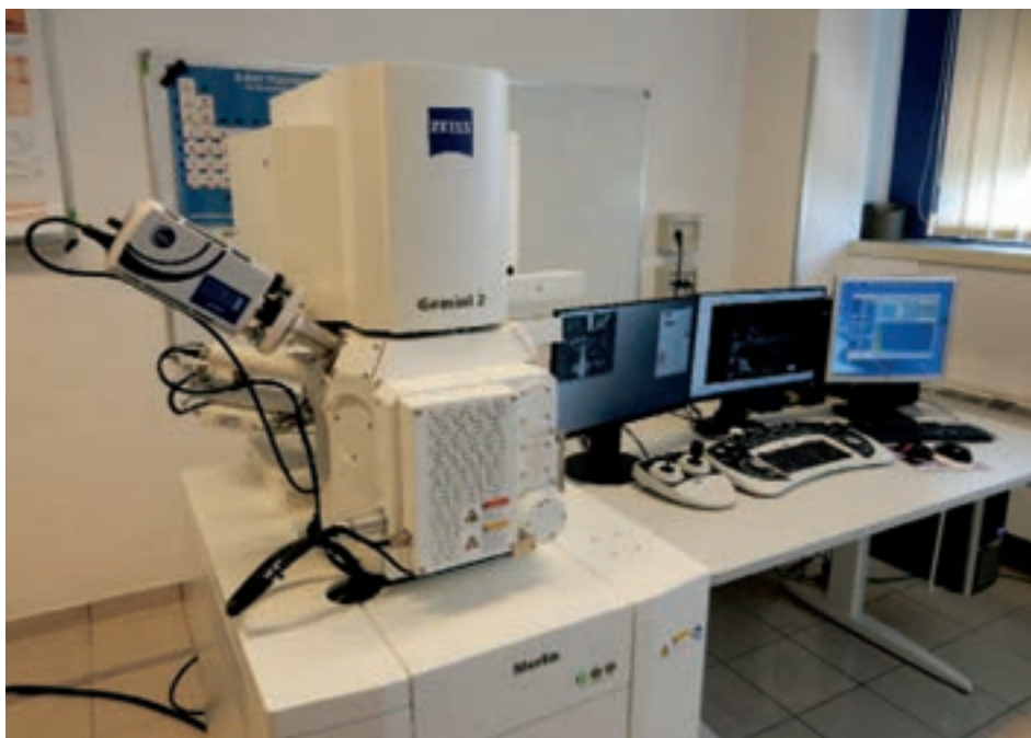
Figura 10 Microscopio elettronico a scansione presente nel Laboratorio rischi agenti cancerogeni e mutageni del Dimeila - Inail
