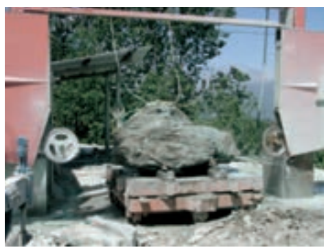
Figura 39 Squadrata dei blocchi grezzi con nastro diamantato
