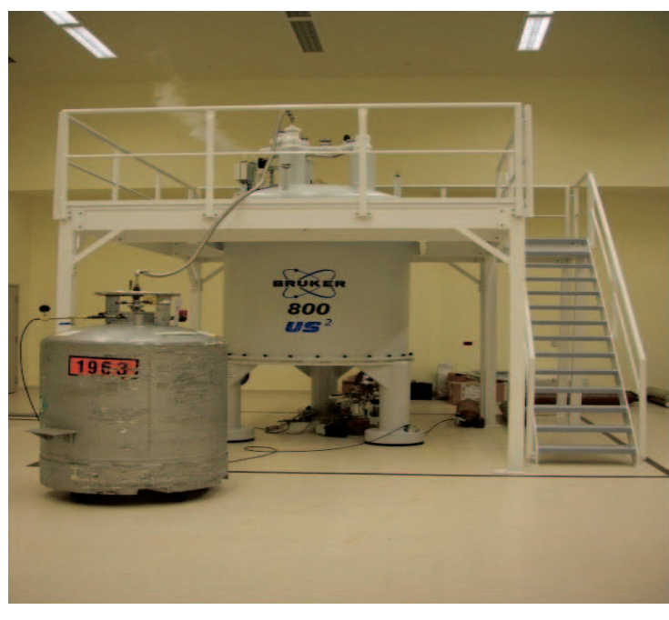
Figura 13 La necessità di realizzare dei palchetti è legata alla grandezza degli spettrometri e quindi all'accessibilità alla testa del magnete
