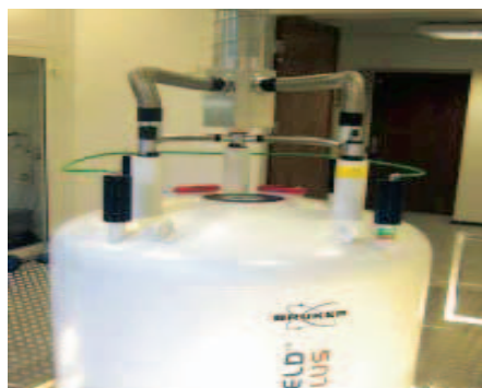
Figura 17 Attacco della tubazione di quench allo spettrometro NMR
