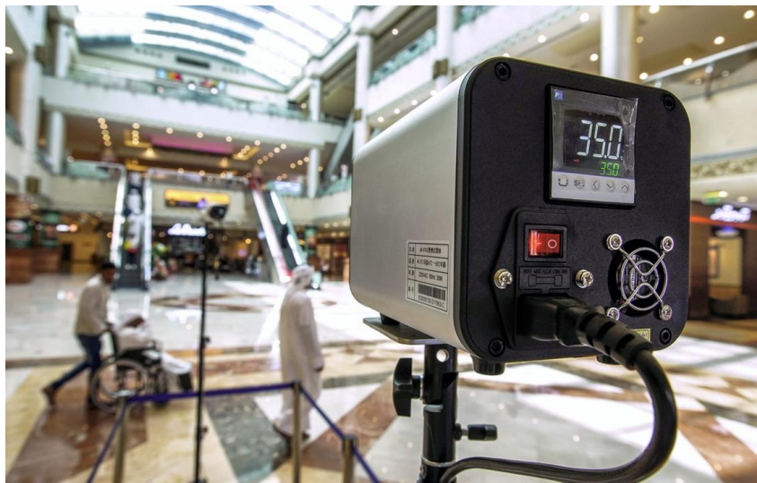
Fig. 1 – Telecamera termica fissa - EN 60601-1:2007 | EN 80601-2-59:2009
