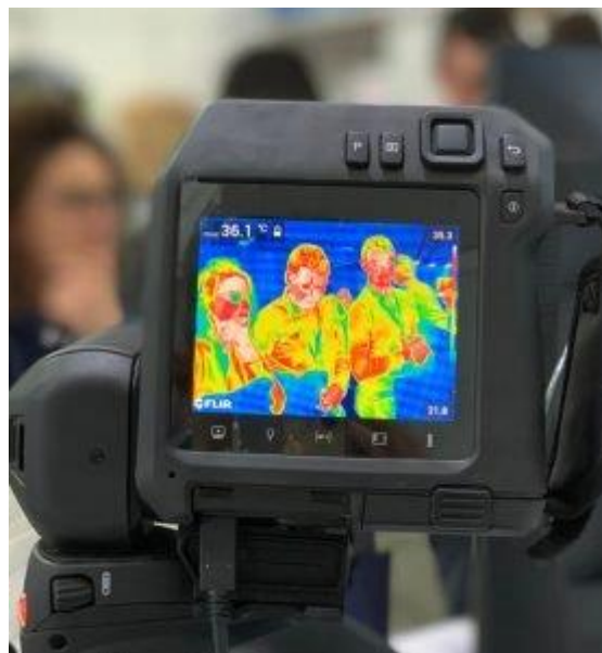
Fig. 2 – Telecamera termica mobile - EN 60601-1:2007 | EN 80601-2-59:2009
