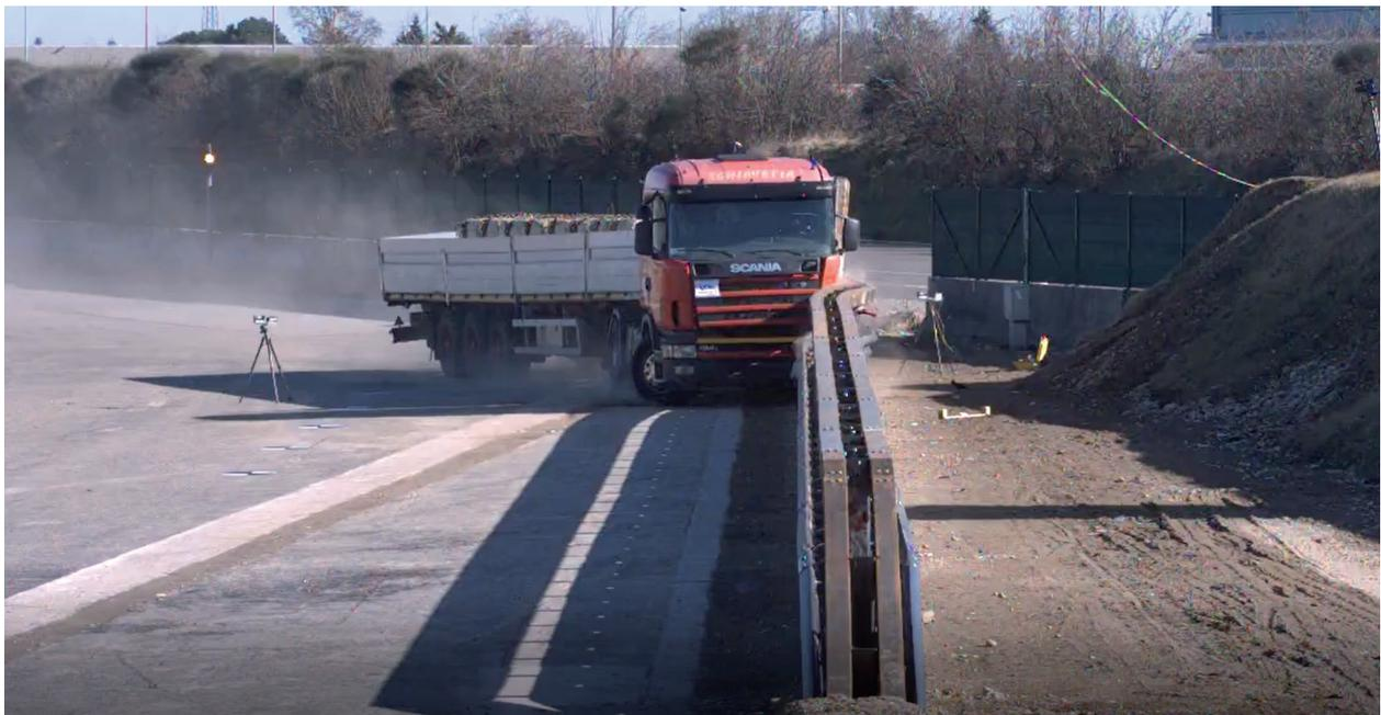
**Figura 4-2:** Verifica contenimento, prova tipo TB 81
