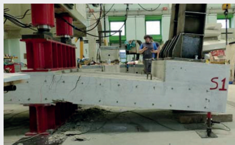
Figura 40. Quadro fessurativo a rottura (viste laterali).
