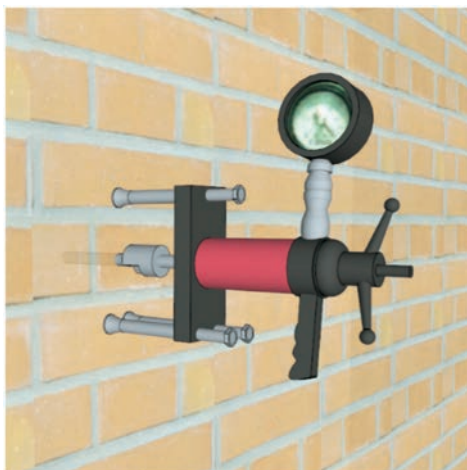
Figura A4.2-1 Test di trazione sull'ancorante
