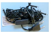
25L LED Una serie di lampade 230V 0.06W 0.02A 3V 50Hz La funzione di controllo Quad 8 Questa Luce può essere collegate in Serie Non può entrare in contatto con i Bambini di meno di
