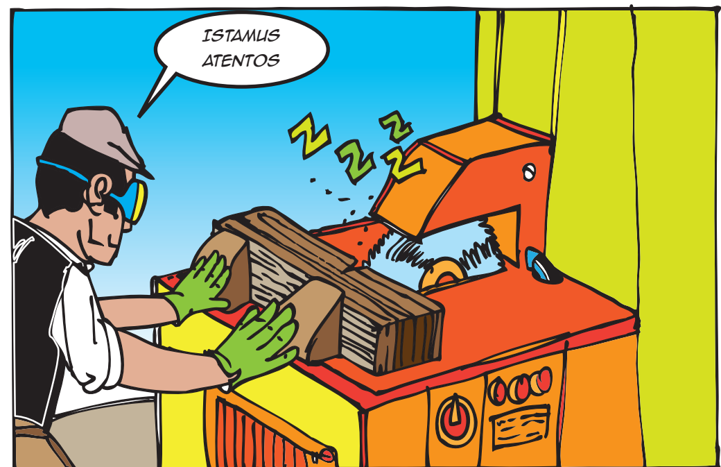
Sega circolare. La lama circolare deve essere protetta. È importante disporre di un sistema spingipezzo.
