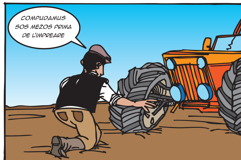
Segnalazione pericolo. Prima dell'uso del mezzo verificare l'eventuale presenza di situazioni anomale che potrebbero causare rotture anche strutturali ai mezzi.
