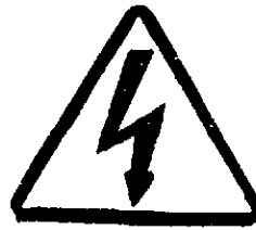
Tensione elettrica pericolosa
