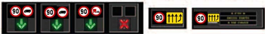
Figura 55 - Etapa 2: procedimiento de apertura y cierre del carril dinámico
