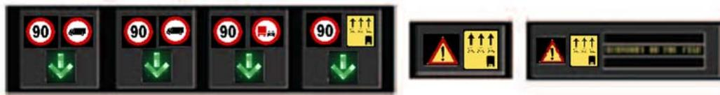
Figura 56 - Etapa 3: procedimiento de apertura y cierre del carril dinámico
