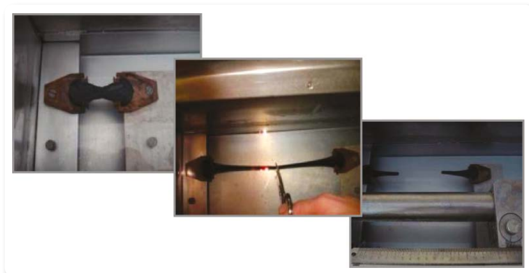
Figura 4.17. Prova di ritorno elastico
