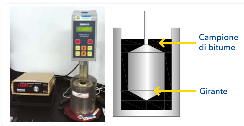
Figura 4.16. Prova di viscosità tramite rotoviscosimetro
