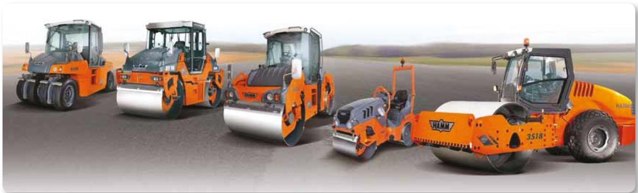
Figura 5.10. Macchine per la compattazione di terre e conglomerati
