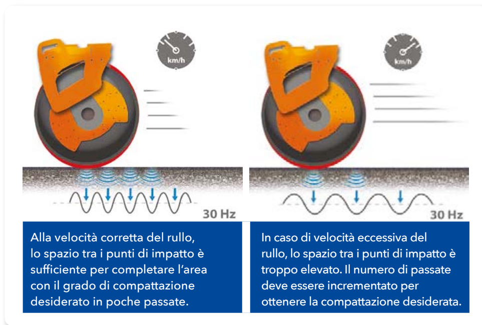
Figura 5.6. Effetto della velocità del rullo: sx) velocità corretta; dx) velocità eccessiva
