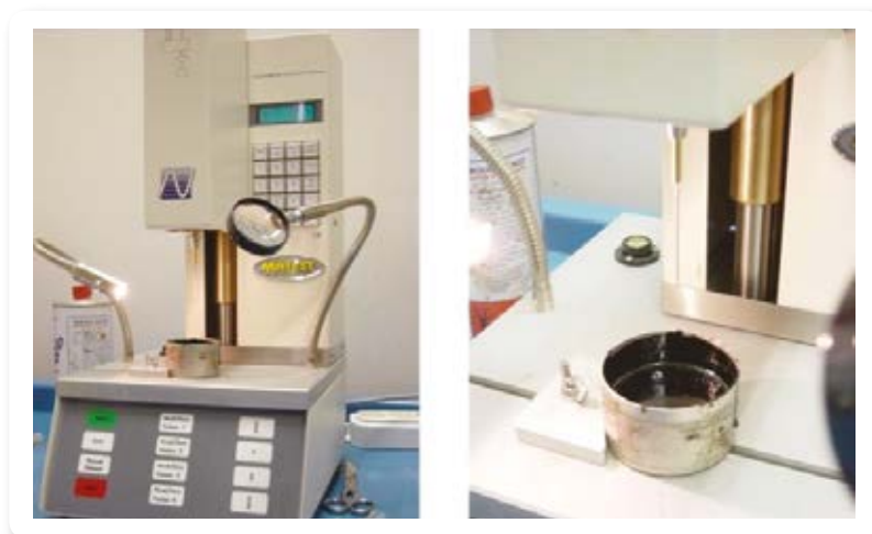
Figura 4.13. Apparecchiatura per la prova di penetrazione
