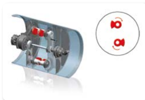
Figura 5.17. Tamburo oscillante: due masse eccentriche (sfasate di 180^\circ ) ruotano e creano un movimento rotante avanti-indietro del tamburo
