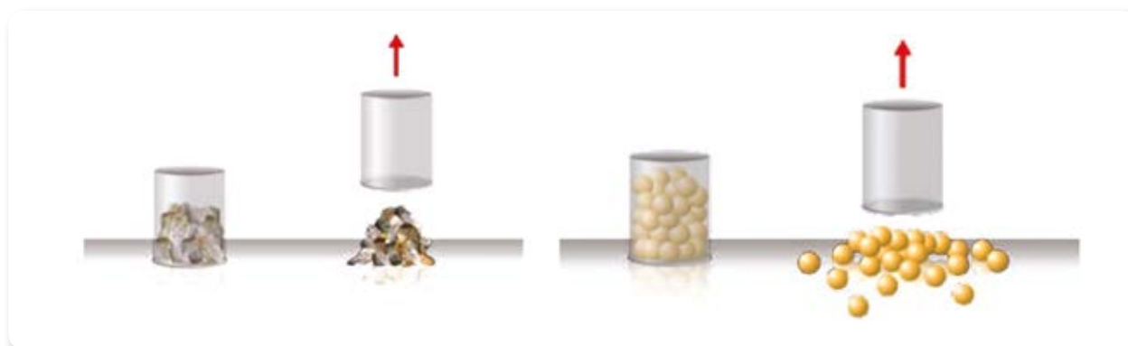
Figura 4.6. Effetto della forma delle particelle: le particelle spigolose si incastrano, rendendo la compattazione più difficile, ma gli strati saranno più stabili (sx). Le particelle di forma rotonda possono essere compattate più facilmente, ma la stabilità finale dello scheletro solido sarà bassa (dx)
