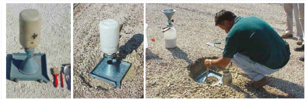
Figura 3.8. Metodo del volumometro a sabbia
