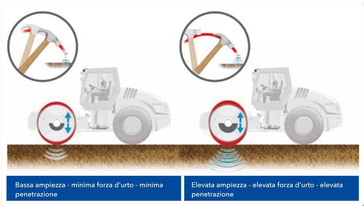
Figura 5.3. Rulli dinamici a vibrazione
