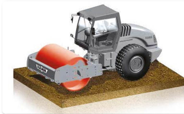
Figura 5.5. Rullo dinamico: massa vibrante
