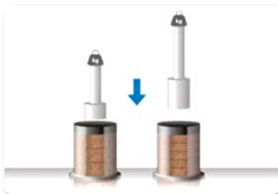
Figura 3.11. Prova Proctor (a sx) e Proctor modificata (a dx)
