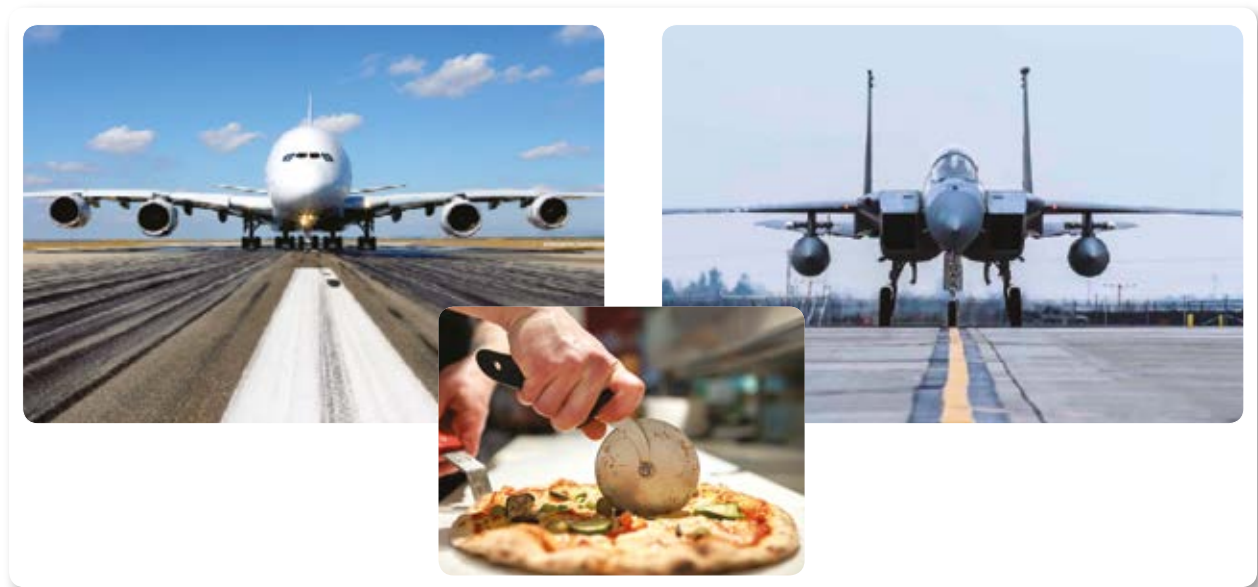
Figura 2.4. Concetto di distribuzione del carico e area di contatto: carico maggiore, ma distribuito su una superficie superiore (in alto a sx); carico inferiore, ma concentrato su una superficie limitata (in alto a dx)
