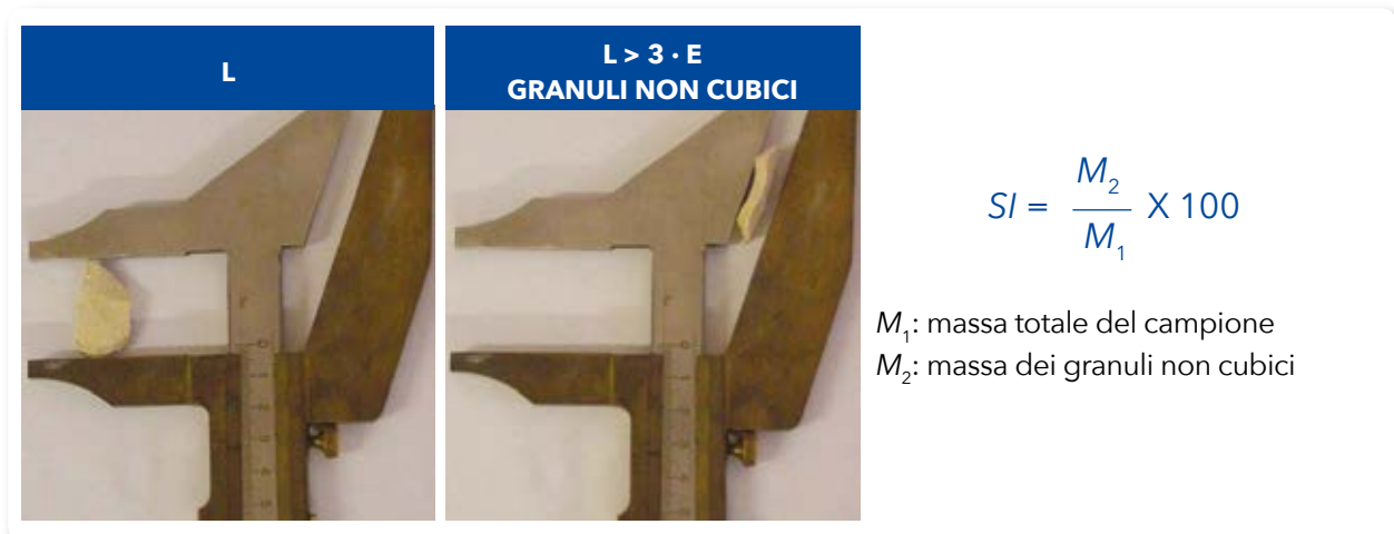
Figura 4.4. Calibro per la determinazione dell'indice di forma (SI)
