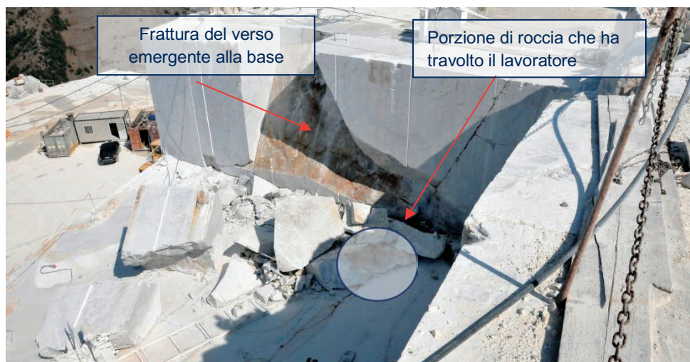
Foto 4 - area di distacco della porzione di roccia
