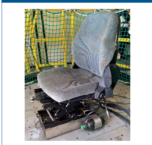
Figura 23 Prototipo di sedile a controllo attivo Inail
