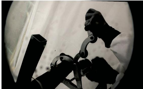
**Figura 15** - Particolare di una lavorazione mediante tagliatubi manuale a catena.
