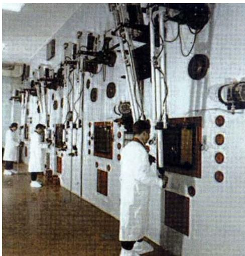
Il Laboratorio OPERazioni Calde (OPEC), entrato in esercizio nel 1962, è stato il primo laboratorio italiano in grado di eseguire analisi di post-irraggiamento su elementi di combustibile irraggiati a uranio metallico e/o a ossido di uranio con attività fino a 2000 Curies (74 TBq).
