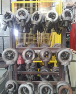
Figura 10 esempio di rastrelliera per il deposito dei golfari
