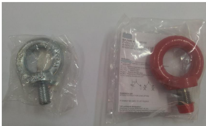
Figura 5 esempi di golfari confezionati e immessi sul mercato. E' da rilevare che quello di destra è accompagnato da idonea documentazione (certificazione di conformità CE e istruzioni d'uso)
