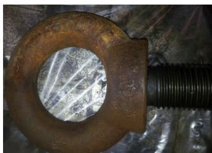
Figura 14 esempio di golfare gravemente ossidato. Tale situazione oltre a non permettere di leggere le marcature riportate sul componente potrebbe comportare una riduzione della sezione resistente pregiudicando la sicurezza dell'accessorio di sollevamento. In questo caso è necessario rottamare il componente.
