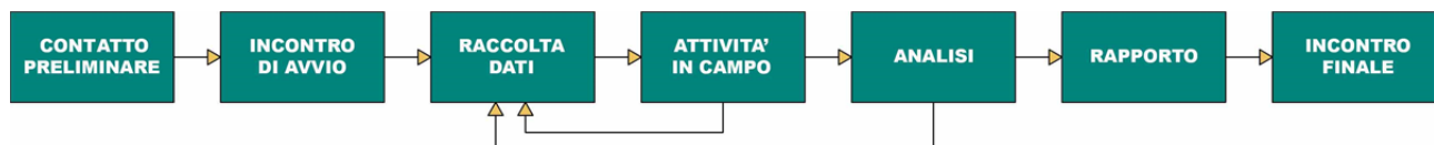
Figura 1 – Diagramma di flusso DE (come da Appendice A - UNI CEI EN 16247-2)
