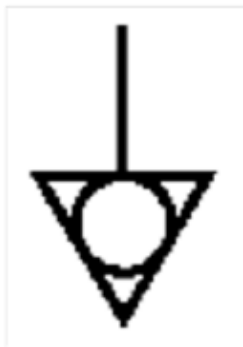
Figura 5 – Simbolo conduttori di protezione equipotenziali.
