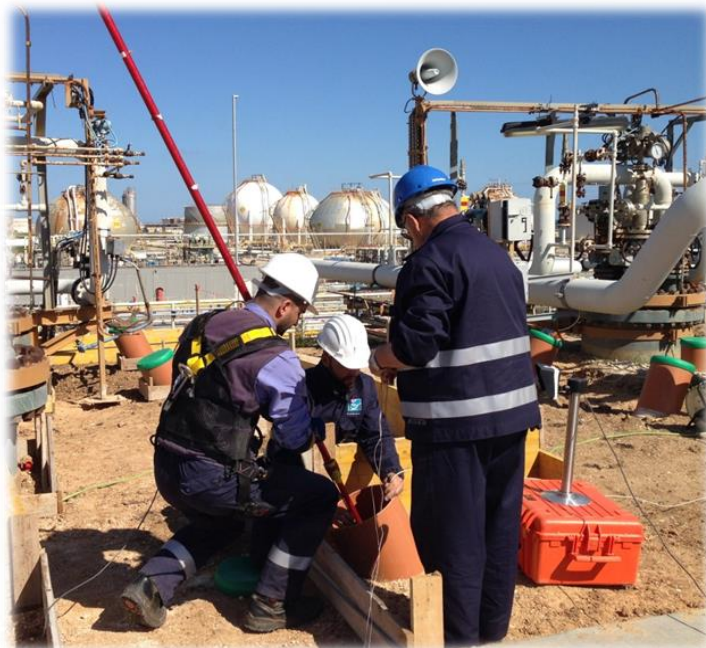
Figura 9. Applicazione dei sensori e calibrazione con mina
