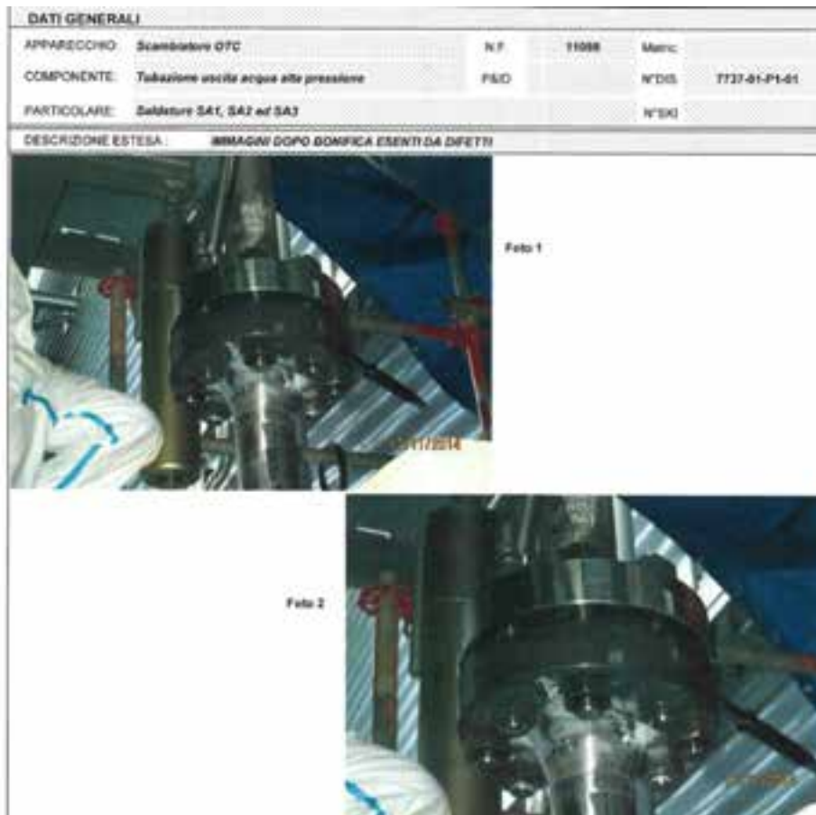
Figura 10. Rapporto Riparazione Centrale di Gissi - Saldature SA1, SA2 e SA3
