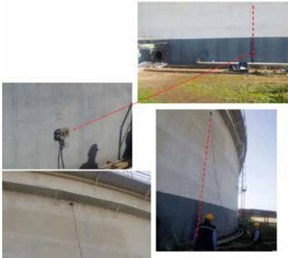
Figura 3. Robot in movimento mentre effettua le scansioni lungo le direttrici del serbatoio cilindrico
