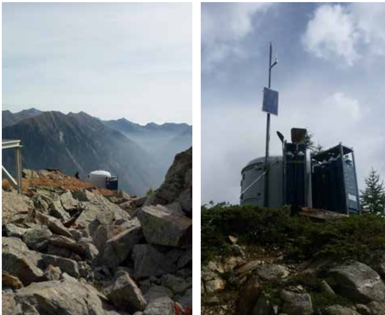
Figura 5. Ubicazione (rispettivamente Monte Rosa e Pila) di sistemi fissi per il distacco artificiale delle valanghe
