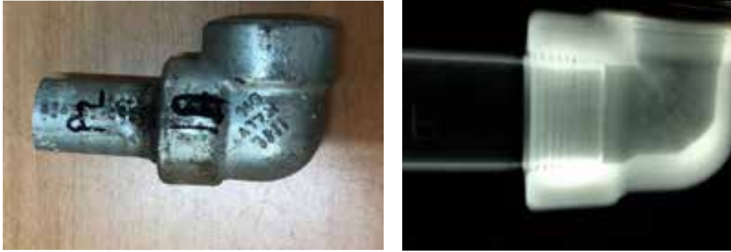
Figura 9. Campione 2: assemblaggio filettato gomito-tubo da \frac{3}{4} "
