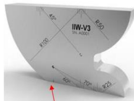
Intaglio per la calibrazione delle creeping
