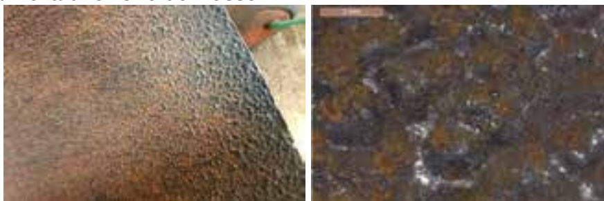
Figura 7. Stereomicrografia superficie interna lato collettore: presenza di "horseshoes" tipiche da FAC
