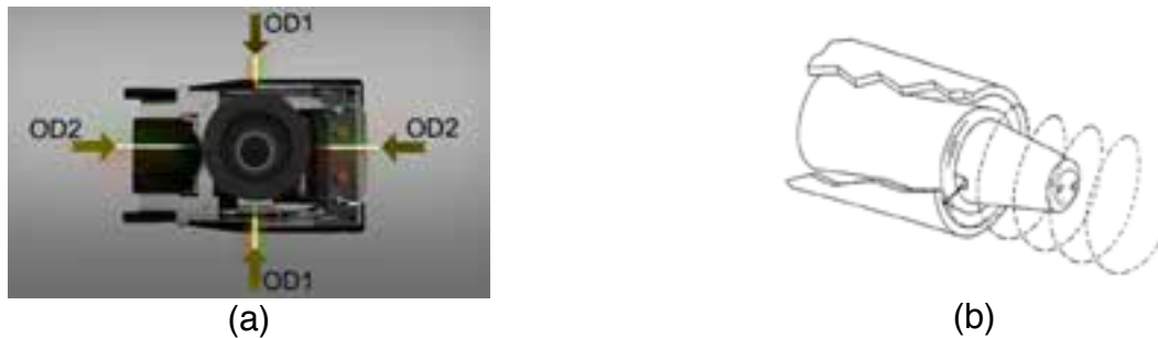
Figura 4. (a) Misura del diametro esterno [6]; (b) Sonda per profilometria Laser [7]
