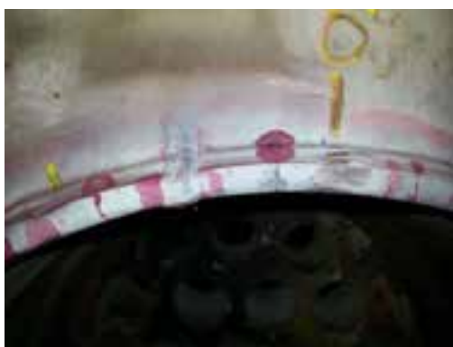
Figura 2. Dettaglio delle cricche rilevate sulla corona attacco bruciatore
