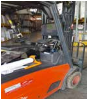
Figura 10. Azienda 2 – Muletto con tablet collegato al server per assegnazione della posizione dei bancali
