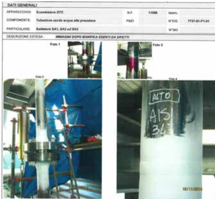
Figura 9. Rapporto Riparazione Centrale di Gissi - Saldature SA1, SA2 e SA3
