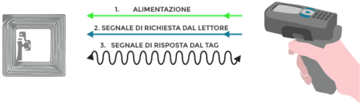
Figura 1. Schema di ricezione del segnale di risposta del TAG [5]
