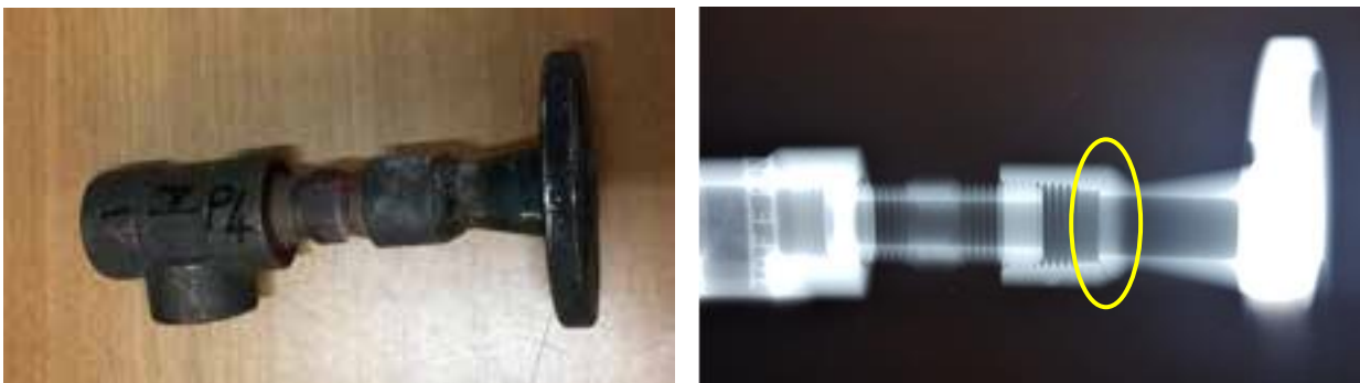
Figura 11. Campione 4: assemblaggio flangia con mezzo manicotto-nipple-tee da \frac{1}{2} "
