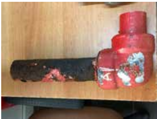
Figura 7. Campione 1: assemblaggio filettato tubo-gomito-tubo da 1½"
