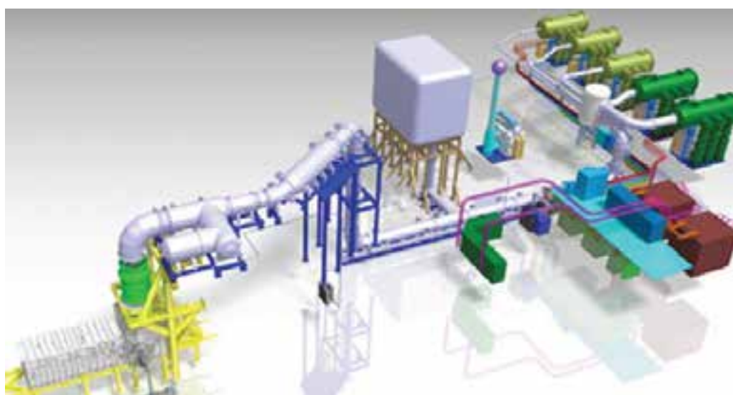
Figura 3. Disegno 3D delle alimentazioni elettriche di MITICA, compresa la Transmission Line e il Vacuum Vessel
