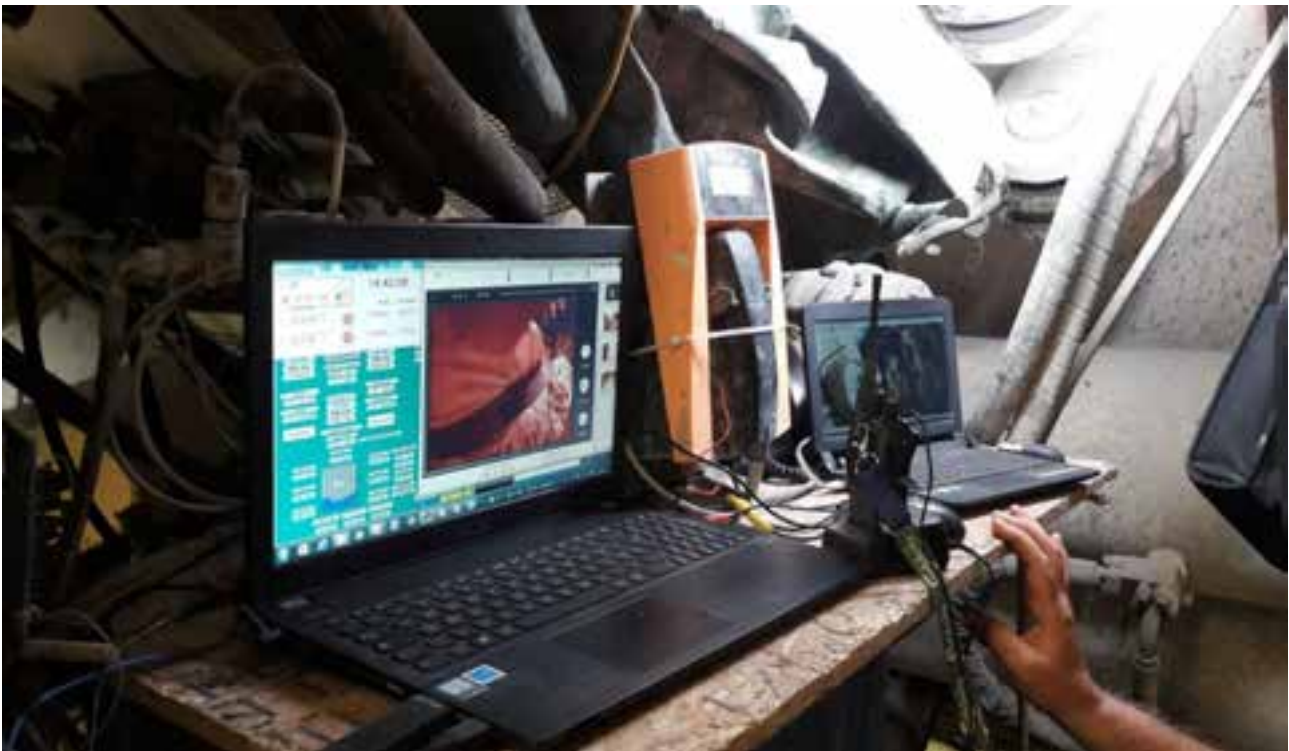
Figura 7. Stazione di controllo in prossimità della camera iperbarica
