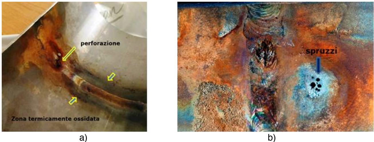
Figura 2. Superficie interna delle tubazioni esaminate: a) ossidazione a caldo, b) spruzzi
