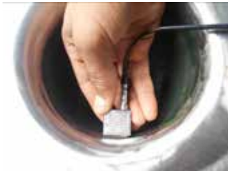
Figura 4.2 Intaglio longitudinale rispetto all'asse del bocchello e relativa visualizzazione dell'eco rilevato con creep wave
