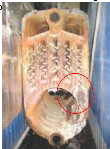
Figura 4. Vista elemento in ghisa del generatore di calore con zona di microfratture
