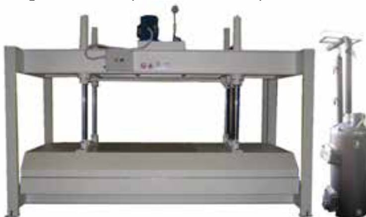
Figura 6. Esempio di pressa a caldo per il legno con caldaia
