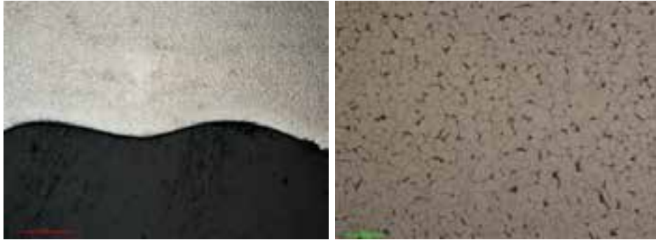
Figura 10. Superficie interna: crateri di cavitazione con assenza di ossido e microstruttura materiale base
