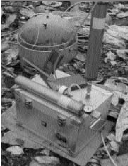
Fig.5.15: Il sistema di campionamento: cappa posta sui rifiuti e valigetta con il compressore che riempie le bombole. La freccia indica il foro attraverso cui viene aspirata l'aria, nel foro si innesta il tubo di teflon verde proveniente dalla cappa (campionamento con cappa dinamica).
