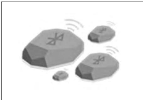
Figura 2 - Proximity Beacon, per l'individuazione delle aree e dei DPI da monitorare
