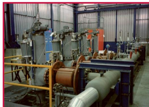
Allestimento sull'impianto VAPORE di 4 valvole di sfioro-sicurezza destinate alla centrale nucleare di Montalto di Castro (anno 1987)
