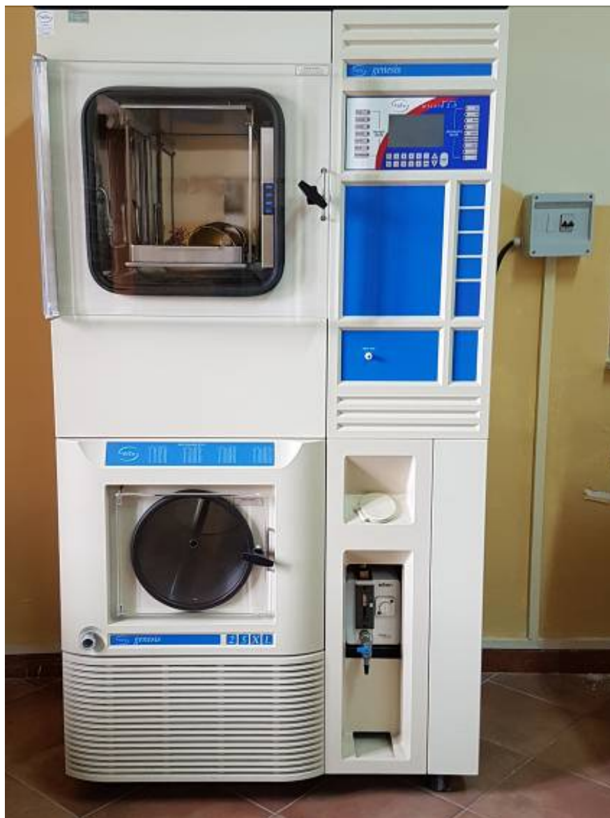
Figura 8. Particolare del Liofilizzatore VirTis Genesis 25 L utilizzato nel Museo Micologico di Acri (CS) [Foto: Carmine Lavorato - © - Archivio Gruppo Micologico Sila Greca - AMB]
